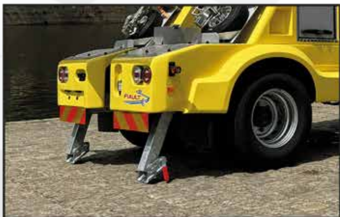
* Deux béquilles arrières avec deux bâches à doigts d'ancrages au sol dans le porte à faux arrière.
