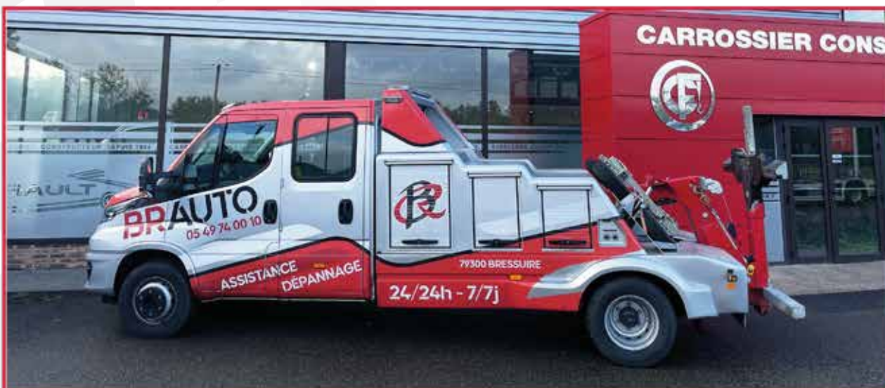
MAXILIFT PF3000 ASSISTANCE avec carrosserie en polyester avec 3 rideaux. Treuil électrique avec groupe électro-pompe ou treuil hydraulique avec prise de mouvement.
