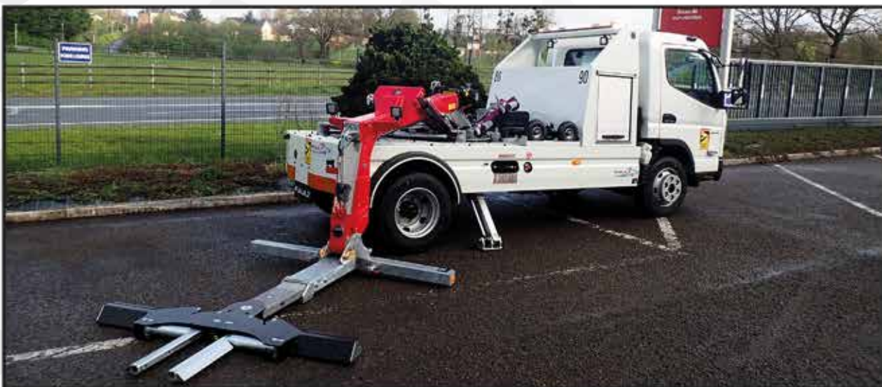
MAXILIFT PF3000 ROTATIF avec carrosserie en aluminium avec 1 rideau, équipement spécial avec tourelle centrale hydraulique permettant une rotation du bras de remorquage et béquillage latéral.
