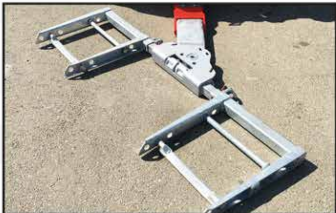
- Tubes et fourches du panier extra-plats hauteur 75mm et entièrement galvanisés avec extension hydraulique.
