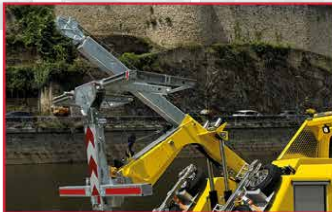
* Flèche de relevage extensible hydrauliquement ou manuellement avec une tête de grue pivotante.
