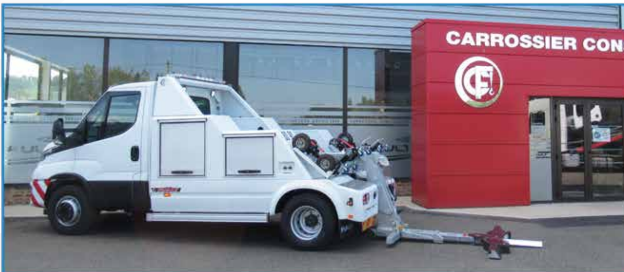
MAXILIFT PF3000 Dépannage avec carrosserie en aluminium avec 1 ou 2 rideaux pour châssis avec empattement court PTAC 3T5 à 8T. Sous bassement en polyester, faux châssis et bras galvanisés à chaud.
