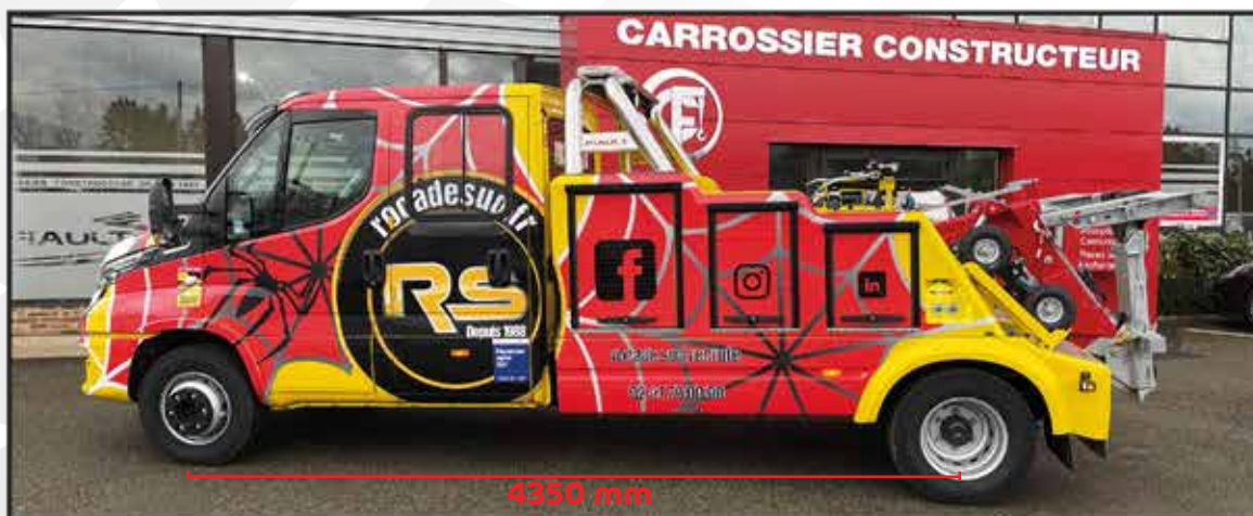
MAXILIFT PF3000 Assistance : Iveco Daily 70C18 HDP avec suspension pneumatique arrière
