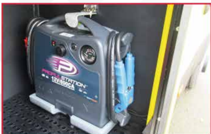
* Un booster propulsion 12V avec station de recharge installée dans un coffre.
