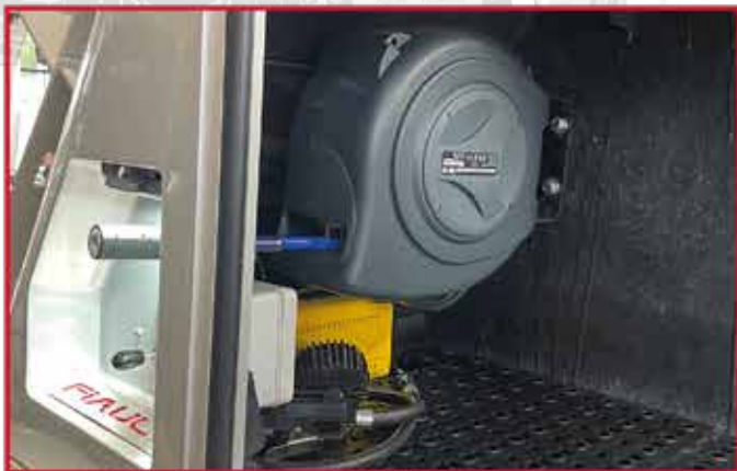
* Un compresseur d'air avec un enrouleur muni d'un tuyau de 15m et manomètre de pression.
