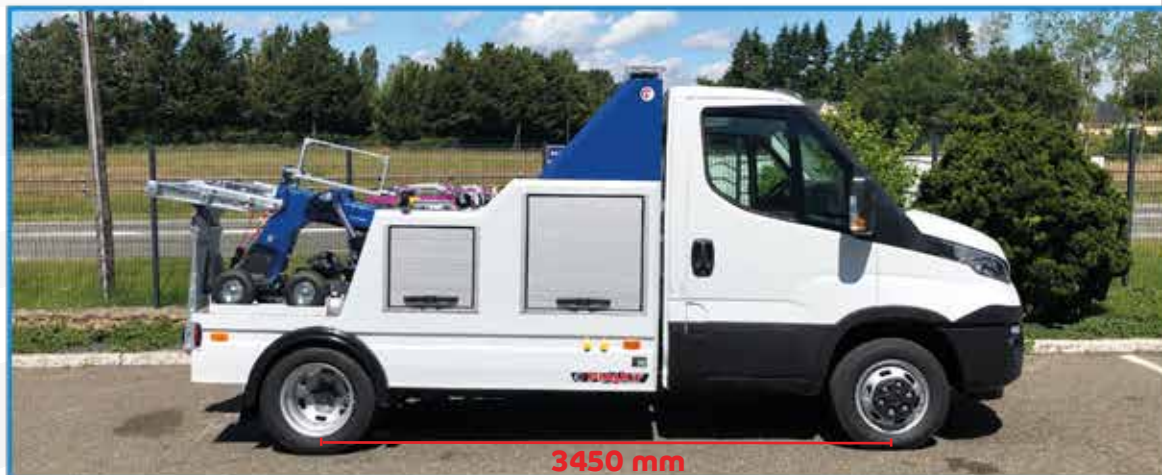
MAXILIFT PF3000 Dépannage : Iveco Daily 35C18 avec suspension pneumatique arrière
