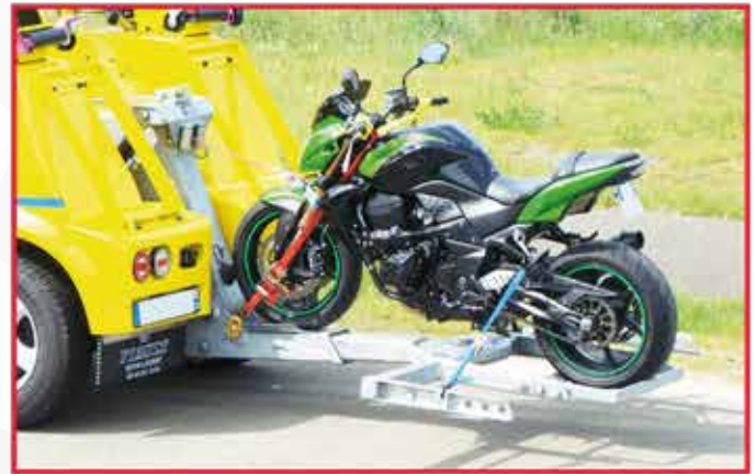
* Equipement porte moto avec adaptation simple et rapide sur panier standard ou automatique.
