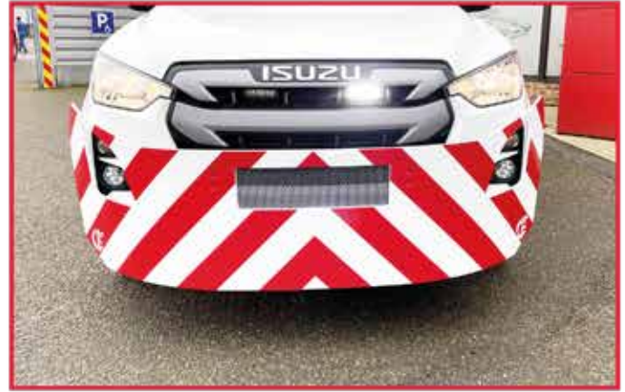
* Pare choc en acier et feux de pénétration installés dans la calandre.
