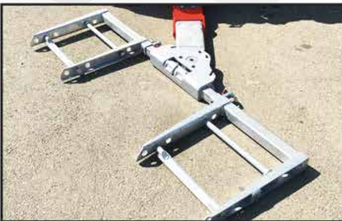
- Tubes et fourches du panier extra-plats et entièrement galvanisés avec extension hydraulique.
