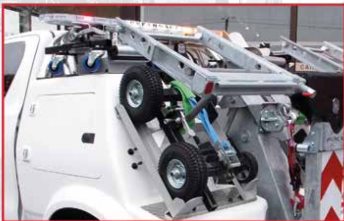
* Chariots de remorquage à roues gonflables type FOURRIERE et à roues pivotantes type CHARRIOTE (50km/h moy)
