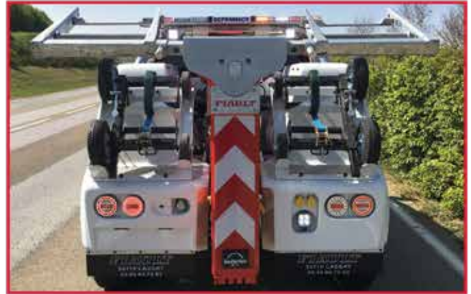
- Feux de signalisation AR 100% leds, phares de travail, prises de remorque et de démarrage 12V.
