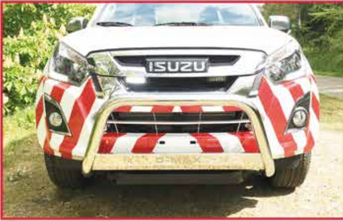
* Pare buffle chromé et lest anti-cabrage positionnés sous le pare-chocs AV.
