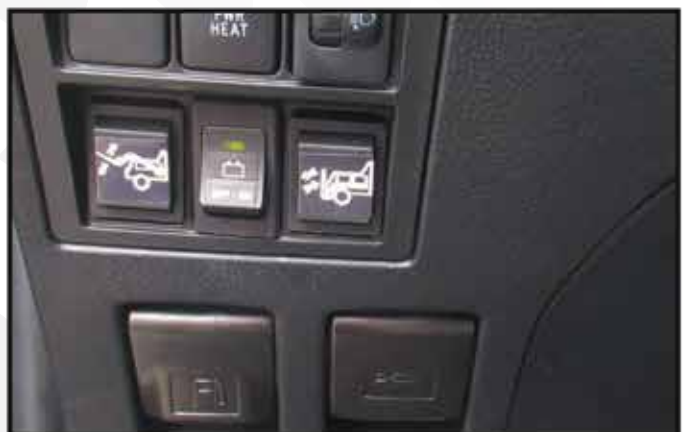
* Coupe circuit électronique et deux interrupteurs en cabine pour élévation et correction du bras.
