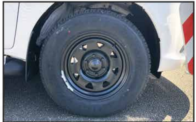
* Remplacement des 4 jantes d'origines par des jantes en ACIER renforcées couleur noires.
