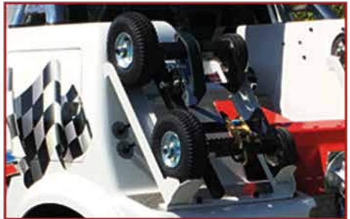
- Deux manipulateurs pour les fonctions du bras et du treuil en complément de la commande radio.
