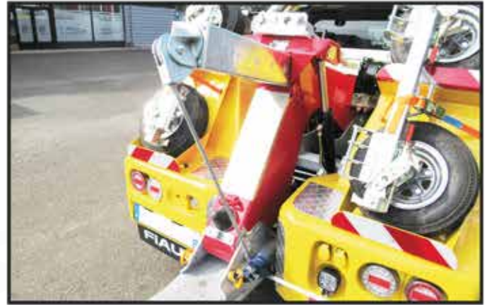
* Une flèche de relevage extensible manuellement avec une tête de grue pivotante et chariots Speed Dolly.
