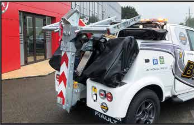
* Tête de grue spéciale MAXILIFT PF3000 pour panier standard ou automatique.
