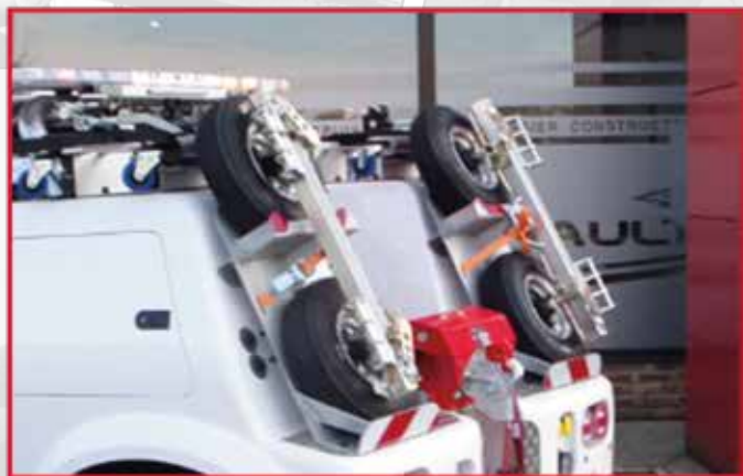
* Chariots de remorquage à roues gonflables type SPEED DOLLY avec supports aluminium en remplacement des marches pied pour les barres.
