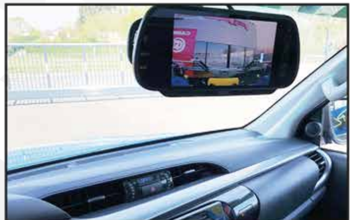
* Caméra de surveillance avec écran plat sur le rétroviseur central
