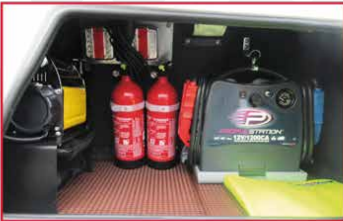
* Booster 12V avec station de recharge dans le véhicule et compresseur d'air avec flexible et manomètre
