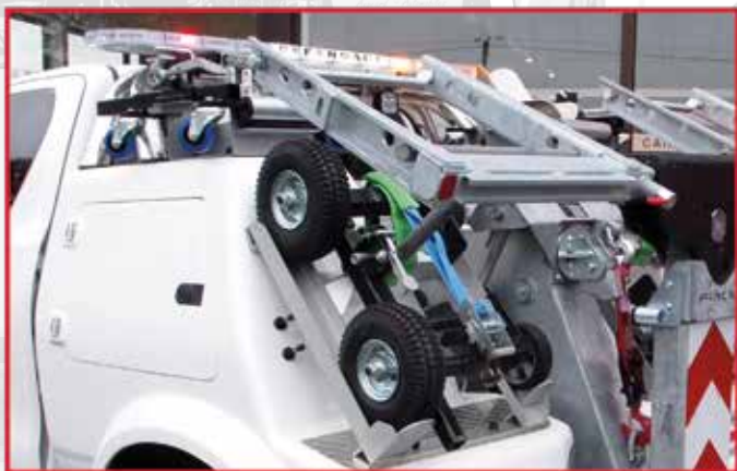
* Chariots de remorquage à roues gonflables type FOURRIERE (50km/h max) et à roues pivotantes type CHARRIOTE
