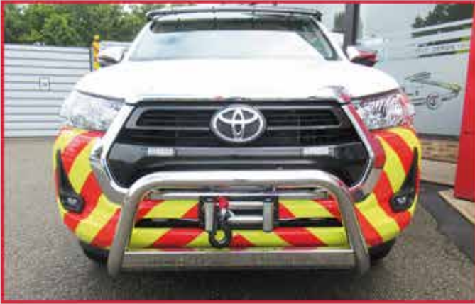
* Pare buffle chromé et visière pare soleil. Lest anti-cabrage positionnés sous le pare-chocs AV.
