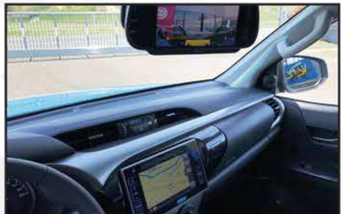
* Caméra de surveillance avec écran plat sur le rétroviseur central et GPS avec système Touch&Go.
