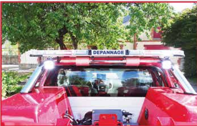
- Rampe lumineuse extra-plate avec rappel des feux de signalisation, treuil électrique 4T avec poulie.
