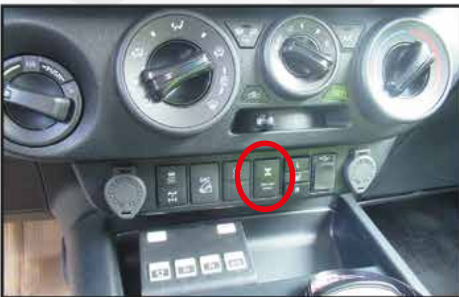
* Débrayage électronique de l'essieu avant avec un interrupteur pour obtenir 2 roues montées en version lente.
