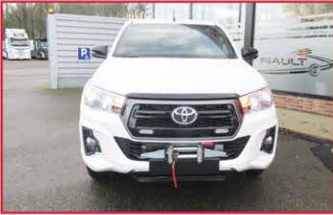
* Treuil électrique 4T encastré dans le pare chocs avant et couplé avec la commande radio.
