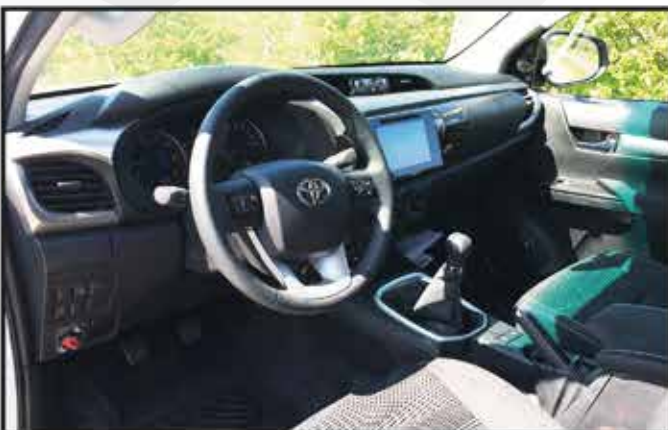
- Ecran d'origine avec caméra de recul et contrôle de la signalisation en cabine.
