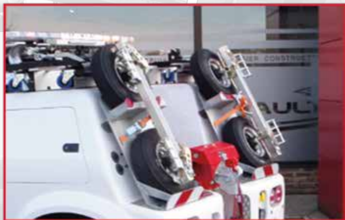
* Chariots de remorquage à roues gonflables type SPEED DOLLY (90 km/h max) et supports aluminium en remplacement des marches pied pour les barres.
