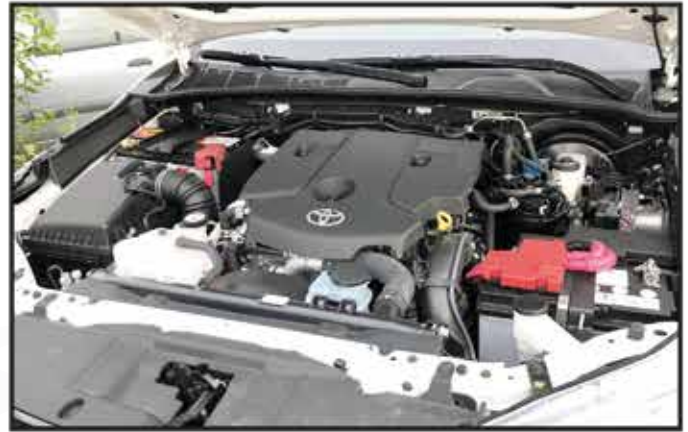
* Adaptation d'une deuxième batterie dans le compartiment moteur.
