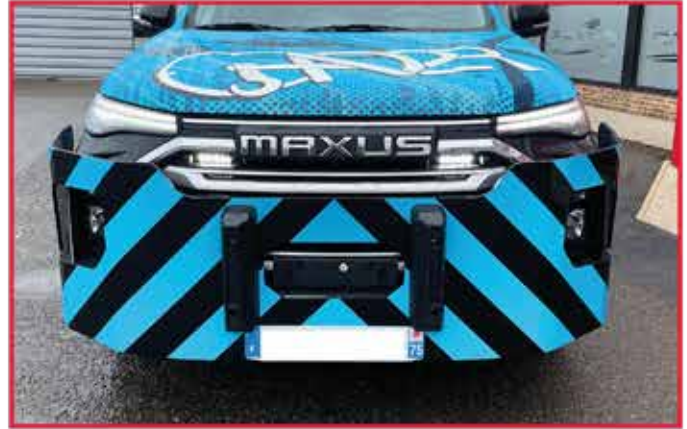
* Pare choc en acier, feux de pénétration et treuil électrique 4T encastrés.
