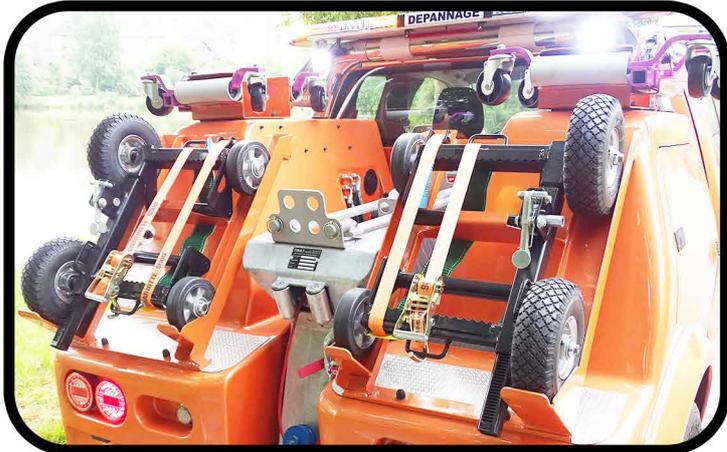
\* Chariots de dépannage à roues gonflables type FOURRIERE et à roues pivotantes type Go-Jack.
