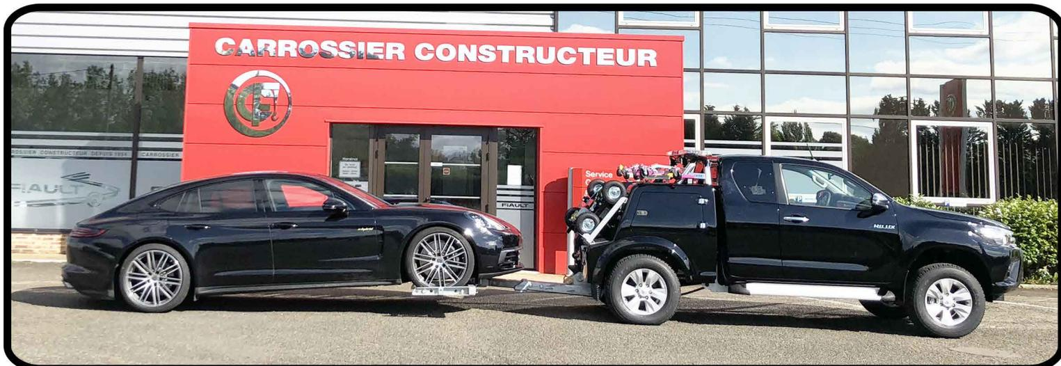
Panier avec 2 vérins d'élévation, 1 vérin de correction et 1 vérin d'extension avec fourches extra-plates.
