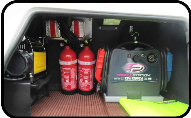
\* Booster 12V avec station de recharge dans le véhicule.
