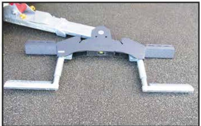
\* Panier automatique type US avec fourches articulées hydrauliquement et radiocommandées.
