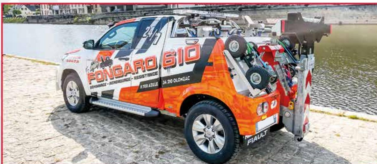
Signalisation arrière protégée et entièrement à leds. Suspension pneumatique arrière avec gestion électronique permettant un abaissement du véhicule à 1,79m
