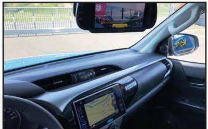
\* Caméra de surveillance avec écran plat sur le rétroviseur central et GPS avec système Touch&Go.
