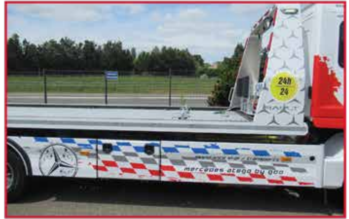
* Carénage stylisé de l'empattement seul en aluminium peint et peinture des portes de coffres
