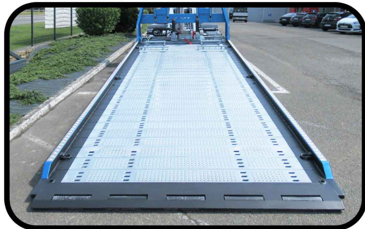
- Plancher avec éléments modulaires GALVANISES type caillebotis avec bords de rives tubulaires 50mm
