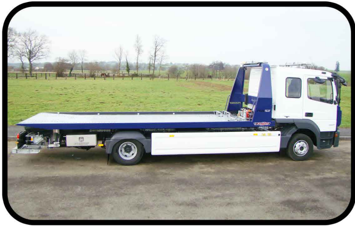
* Carénage stylisé de l'empattement seul en polyester
