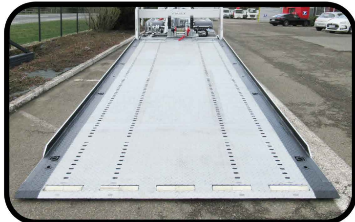
* Plancher en tôles renforcées à LARMES GALVANISE à chaud ép. 4/6 avec bords de rives avec cornière 12mm
