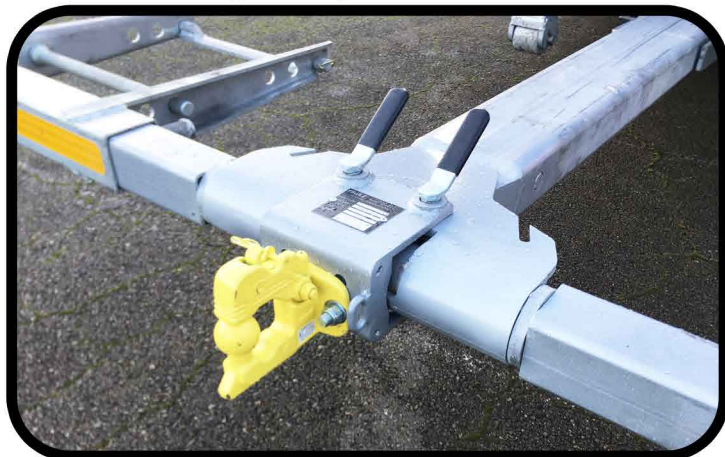
* Chape + boule adaptable sur panier de remorquage
