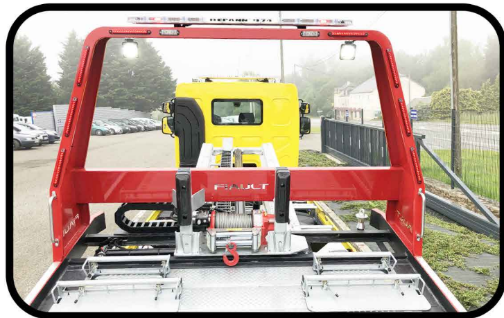
* Roll-bar surélevé type FLY, rampe lumineuse avec rappel des feux, feux flash et éclairage à leds
