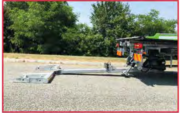
* Panier de remorquage avec double extension hydraulique à 1800mm
