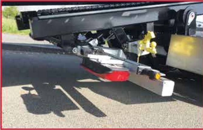
* Béquilles de stabilisation arrière et pare-chocs pivotants hydrauliquement (équipement sans panier)
