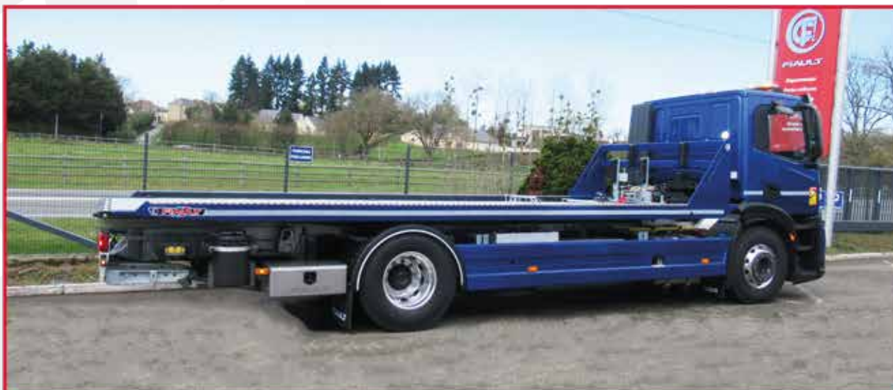
Système de coulissement breveté par l'intermédiaire d'un moteur réducteur avec une chaîne sur une poutre centrale.
