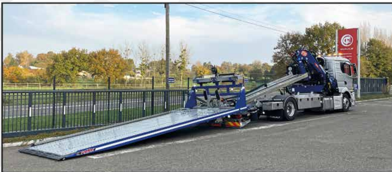
Angle de chargement le plus faible du marché 2 à 5° pour le passage de tous types de : voitures, campings-cars, ect...
