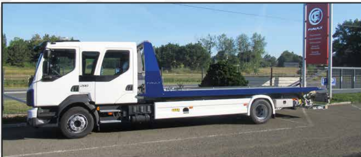
Angle de chargement le plus faible du marché 2 à 5° pour le passage de tous types de : voitures, campings-cars, ect...
