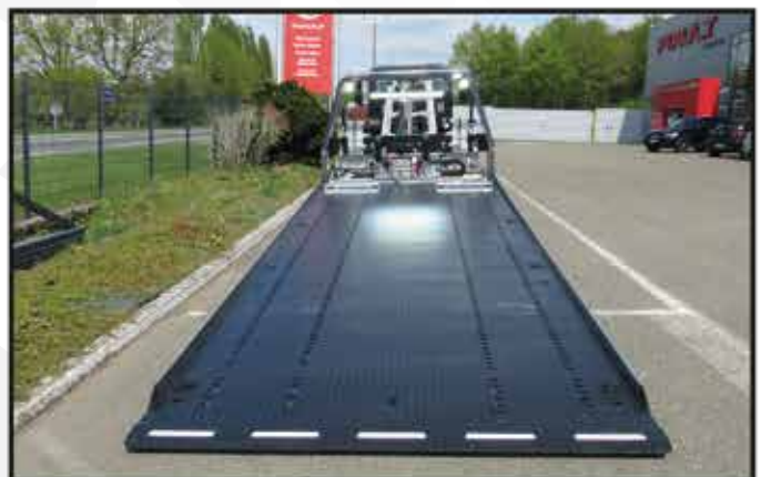
* Plancher en tôles renforcées à LARMES PEINT ép. 4/6, bords de rives avec plats 10mm
