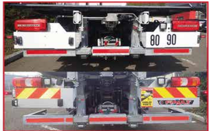
* Système unique de relevage du panier derrière les feux arrière pour améliorer l'angle de chargement
