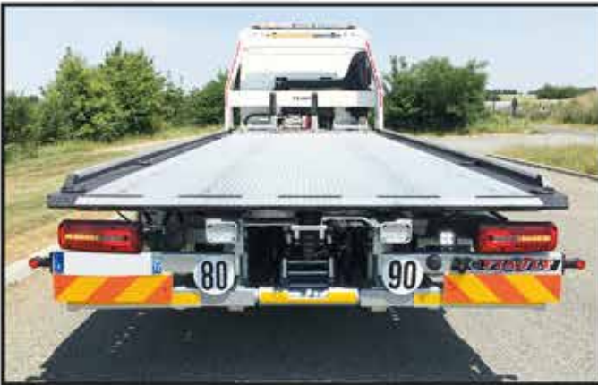
* Treuil hydraulique sur le panier et béquilles relevables afin d'optimiser l'angle de chargement
