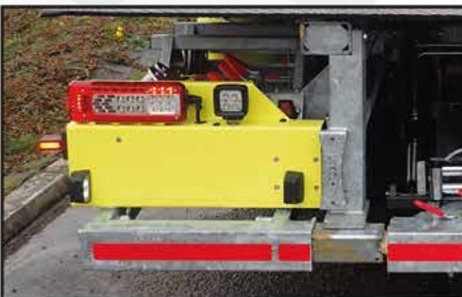
* Peinture des deux tôles de support de feux arrière en un ton uni standard (à indiquer)
