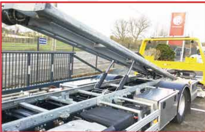
* Système breveté de coulissement par moteur réducteur + chaîne centrale et galvanisation totale
