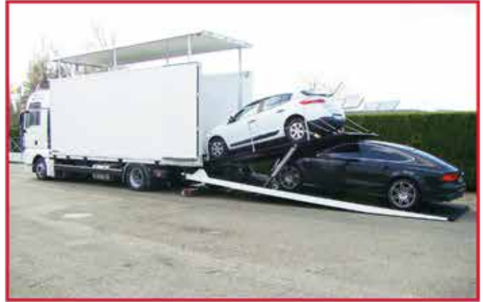
* Gerbeur hydraulique positif à l'AV et carrosserie avec panneaux rigides + toit réhaussable
