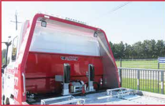
* Habillage du FLY avec doublage intérieur en aluminium et fermeture à mi-hauteur
