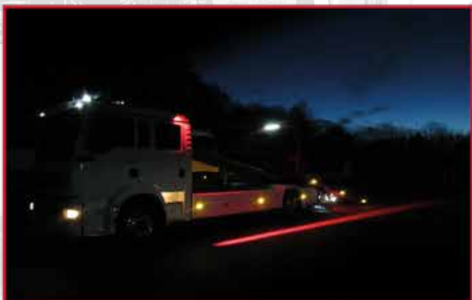
*Projecteur à led rouge pour délimiter un corridor de sécurité côté conducteur
