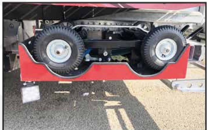
* Support ouvert sous plateau pour chariots FOURRIERES
