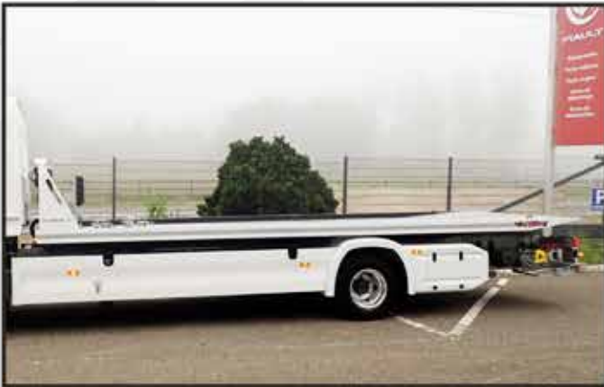
* Carénage stylisé intégral de l'empattement en alu avec ailes et coffre arrière en polyester
