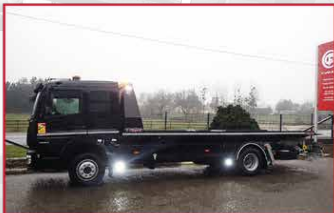
*Quatre phares de travail d'éclairage périphériques en partie basse (2 par côté)
