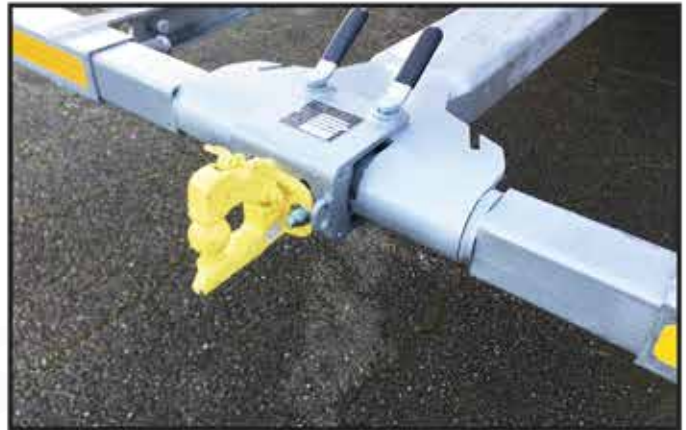
* Chape + boule adaptable sur panier de remorquage
