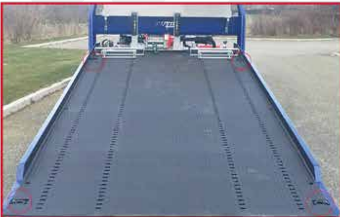
* Anneaux d'arrimage articulés, soudés ou encastrés dans le plancher
