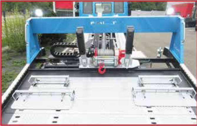
- Roll-bar avant standard avec butoirs amovibles, treuil hydraulique à déplacement radiocommandé
