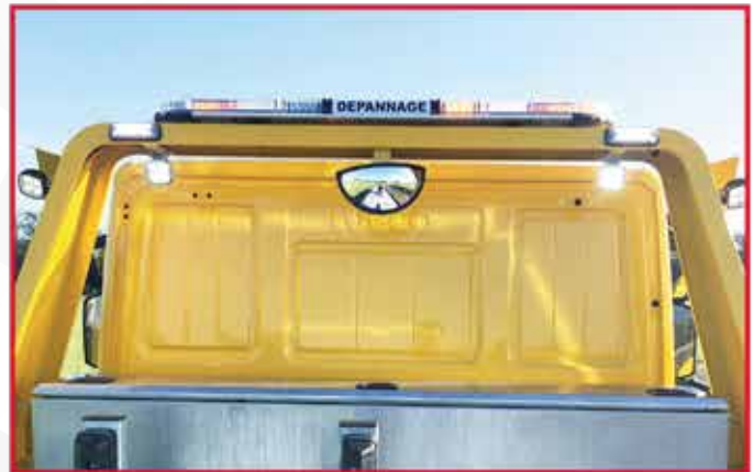
* Un miroir panoramique d'aide à l'approche du véhicule sur le plateau
