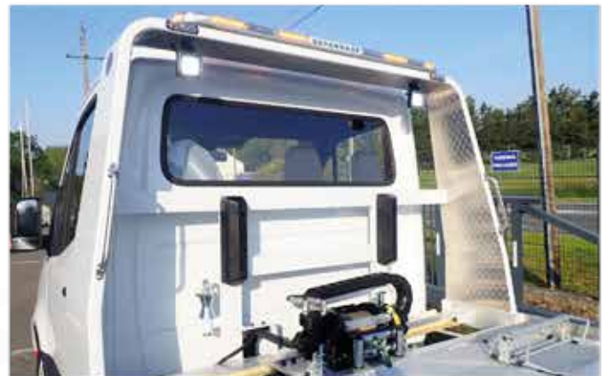
* Roll-bar surélevé stylisé type FLY modèle LUXE avec angles arrondis, habillage en alu et poignées en inox.
