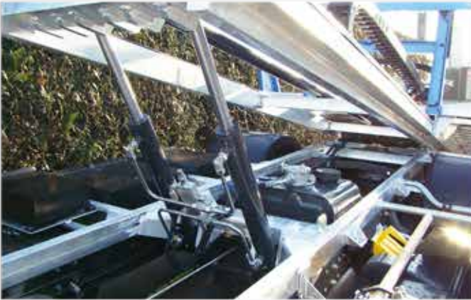
- Technologie par profilés extrudés pour le basculeur et le plateau pour augmenter la solidité de l'ensemble.
