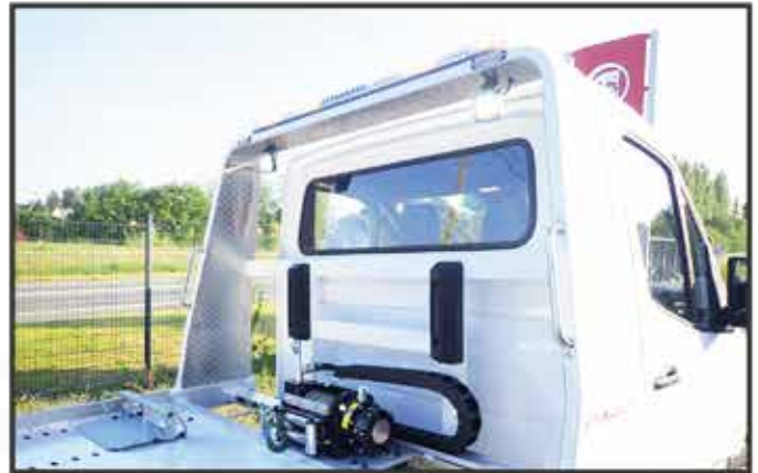
* Deux feux de pénétration sur FLY, phares de travail à leds et câble nylon pour treuil.
