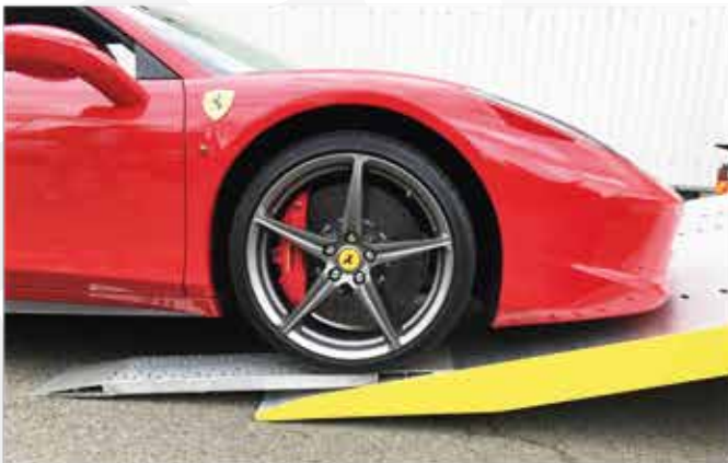
* Deux rampes manuelles d'amélioration de l'angle de chargement avec support sur l'équipement.
