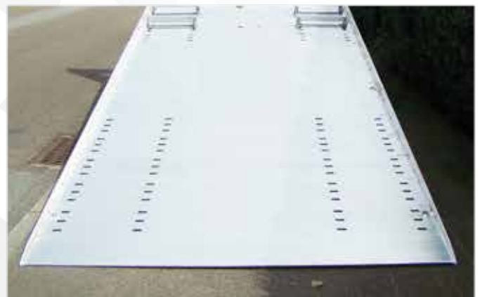
* Plancher aluminium autoportant anti-dérapant sans nervures de renfort.
