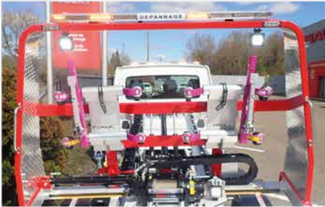
* Chariots Go-Jack 5211 avec supports (brevetés) sur le roll-bar surélevé type FLY.
