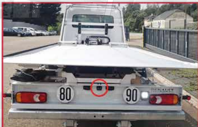
* Caméra de recul en couleur installée à l'arrière de l'équipement avec écran plat dans la cabine.
