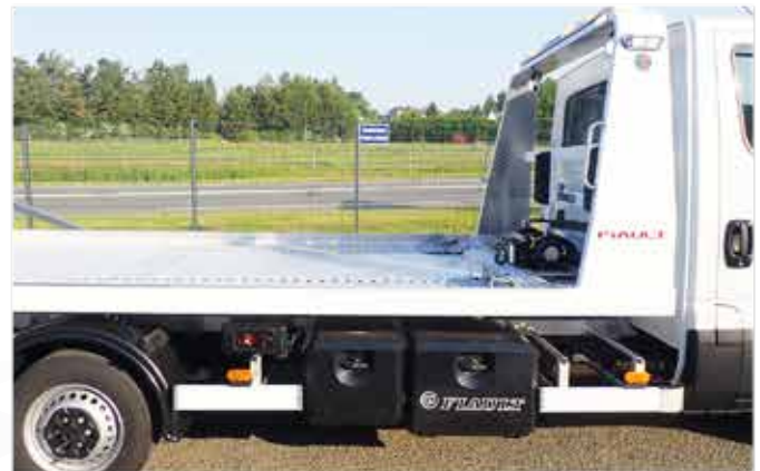
* Coffres à outils en polyuréthane et équipements carte blanche (cônes, pelle, balai, bac à sable, extincteurs).
