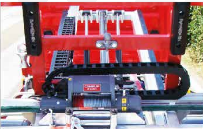
- Treuil électrique 4T avec déplacement manuel et commande à distance radio.
