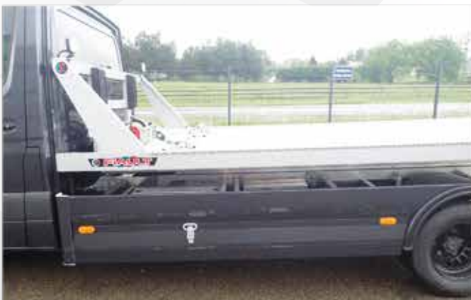
* Carénage de l'empattement en aluminium.
