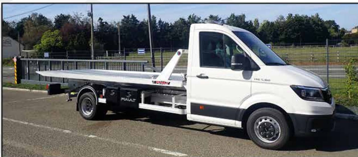
Basculement et coulissement par groupe électro-pompe ou prise de mouvement.
