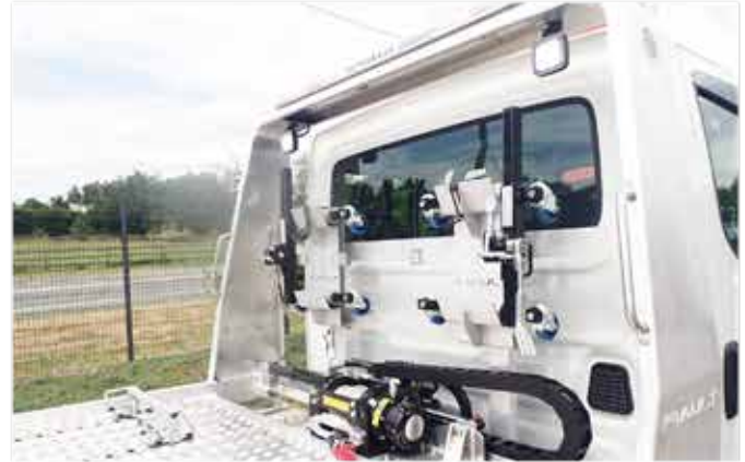
* Chariots type CHARIOTTE avec supports (brevetés) sur le roll-bar surélevé type FLY.
