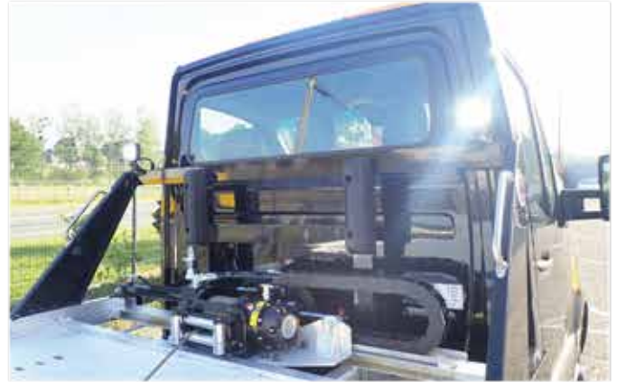
- Roll-bar standard avec deux butoirs caoutchouc.
