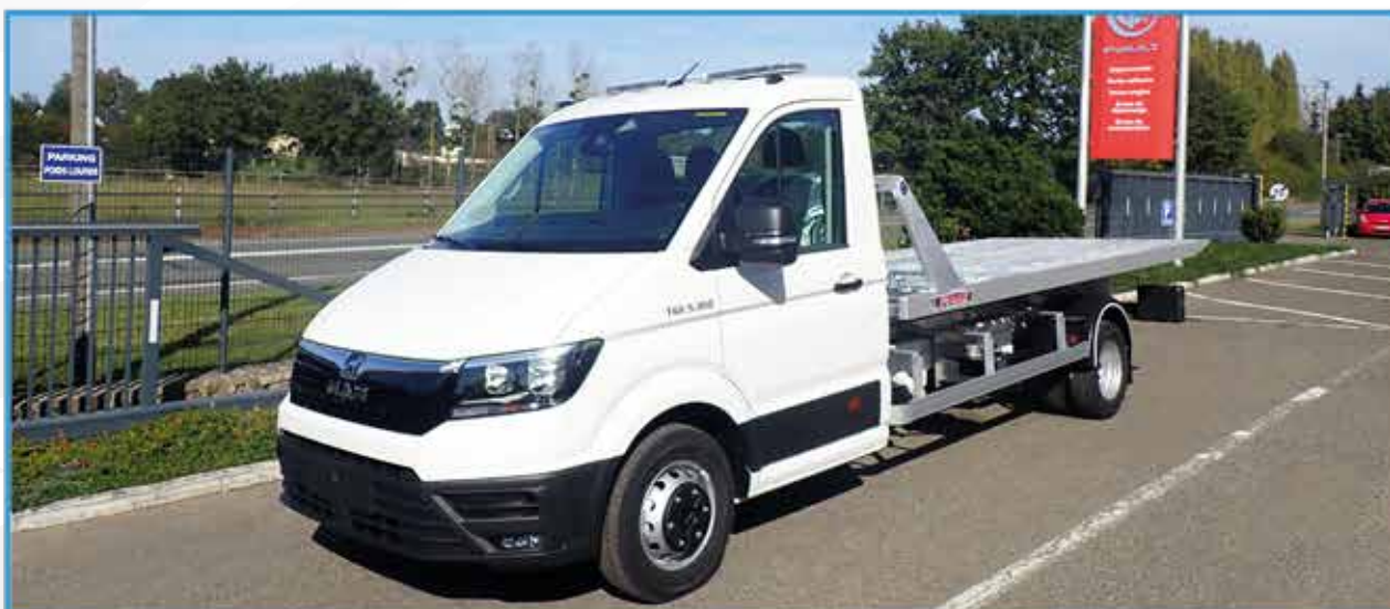
Faux-châssis - Basculeur - Plateau 100% Aluminium soudé Longueur 4900 mm x Largeur : 2100 mm.
