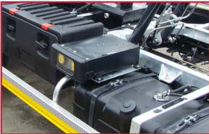
* Prises de démarrage 12V dans un coffre de protection avec câbles de démarrage.
