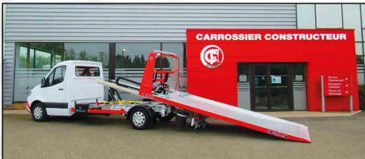
Basculement et coulissement par groupe électro-pompe ou prise de mouvement.
