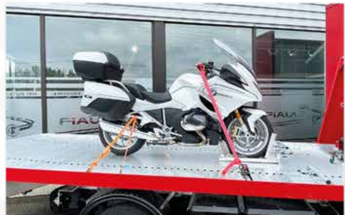
* Cale spéciale moto avec un sabot pour emboîtement de la roue et support sous le plateau.
