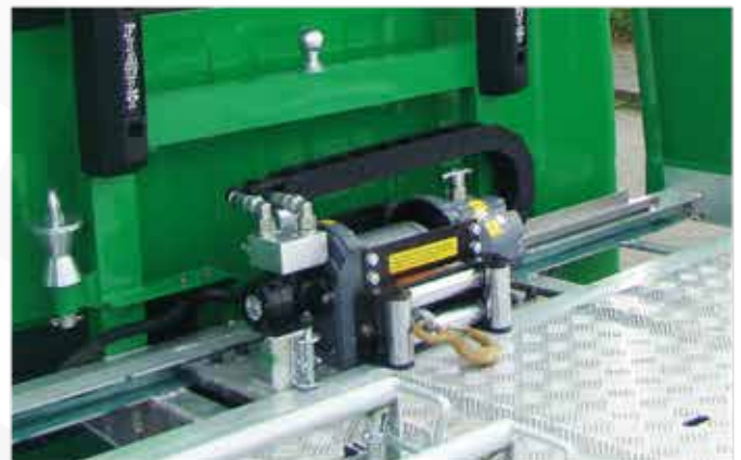
* Treuil hydraulique 3T6 (sur véhicule équipé avec PTO) avec déplacement manuel et commande à distance radio.
