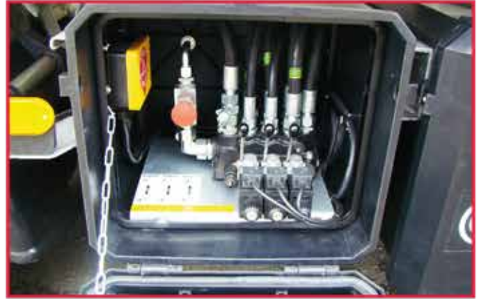
- Coffre de commande hydraulique en complément de la commande radio en version hydraulique.
