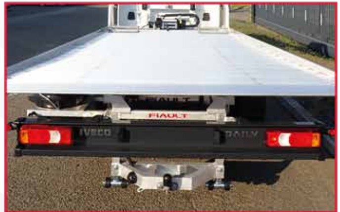
- Deux béquilles arrières de stabilisation réglables en hauteur avec 4 roues d'appui au sol et crochet d'attelage.
