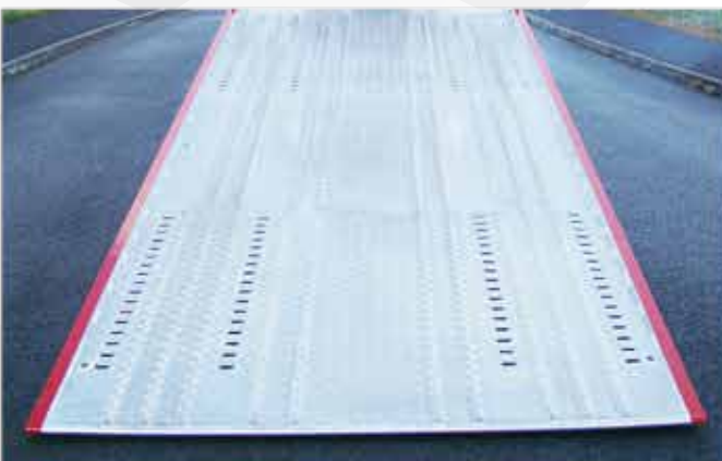
- Plancher aluminium en tôles à larmes anti-dérapantes avec nervures de renfort.
