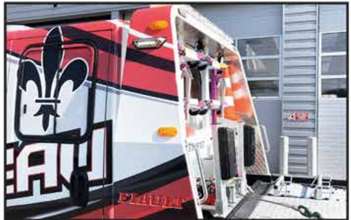
* Phares de travail chromé d'éclairage périphérique installés en partie haute du FLY.
