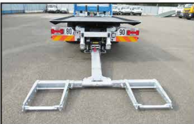
* Panier de remorquage galvanisé et réglable type AUTOLIFT 2T et treuil hydraulique 3T6.
