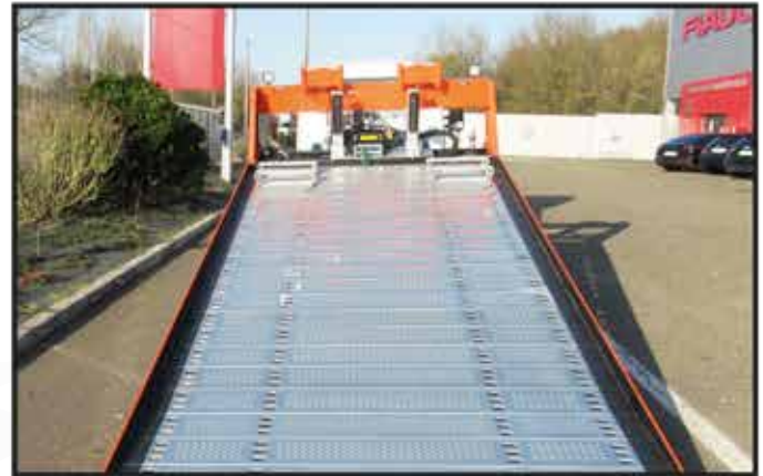
- Plancher caillebotis en acier galvanisé, bords de rives minces 10mm avec largeur utile 2180mm.
