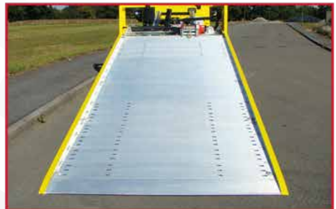
* Plancher AUTOPORTANT en aluminium, bords de rives tubulaires.
