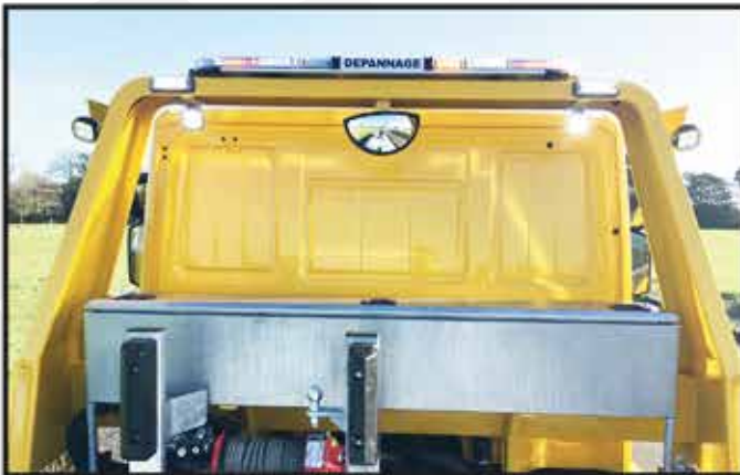
* Un miroir panoramique d'aide à l'approche du véhicule positionné sous le roll-bar avant.
