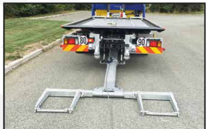
* Treuillage sur le panier par le treuil du plateau.
