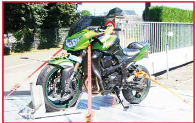
* Porte moto compact en aluminium avec support sur l'équipement et sangles spéciales moto.
