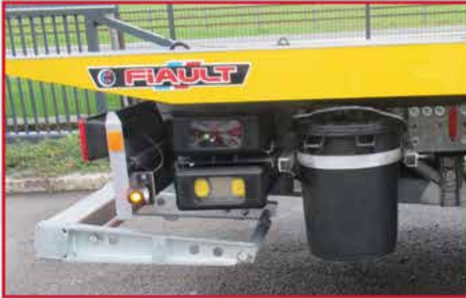
* Deux câbles de démarrage avec deux prises 12V et un bac à sable avec support coulissant.
