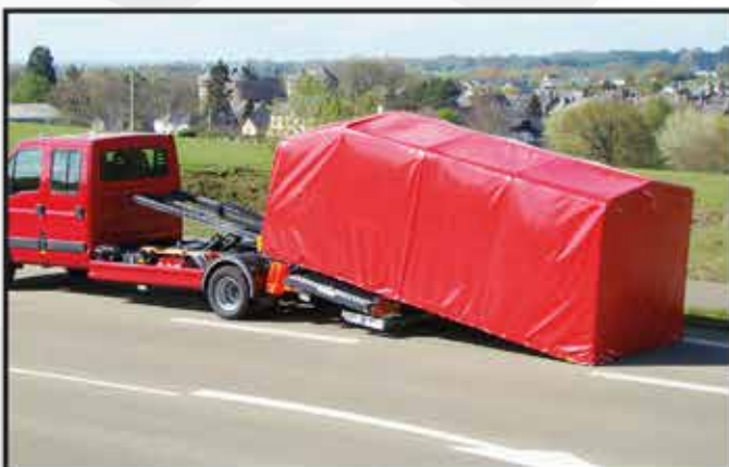
* Bâchage intégrale du plateau.
