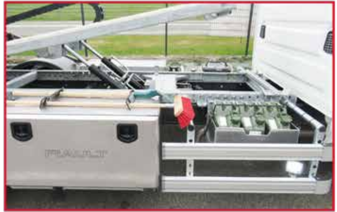
* Coffre à outils en inox avec porte articulée, 3 jerricans et éclairage périphérique.
