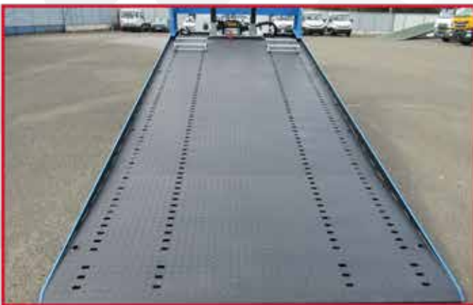
* Plancher acier en tôles à larmes peint, bords de rives minces 10mm avec largeur utile 2180mm.
