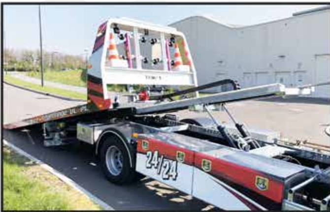
* Galvanisation intégrale de l'équipement (faux châssis, basculeur, plateau, accessoires).
