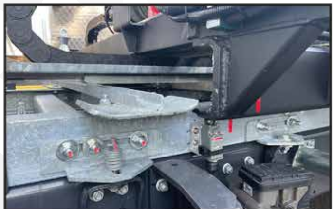
* Capteur électrique pour éviter le basculement du plateau lorsqu'il est dans le verrouillage avant.
