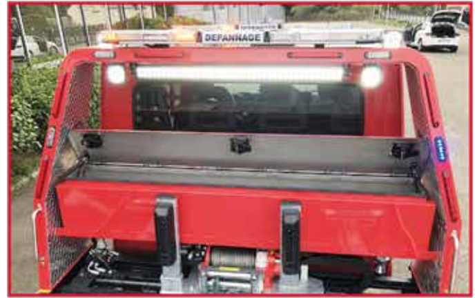
* Roll-bar surélevé type FLY, coffre de rangement, rampe lumineuse avec rappel des feux et feux flash.
