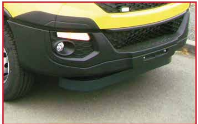
* Adaptation d'un bloc de lest anti-cabrage sous le pare chocs d'origine pour améliorer la tenue de route.
