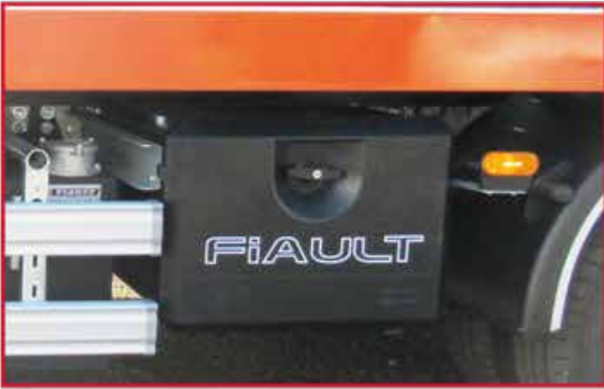
* Coffre à outils anti-chocs en polyuréthane.
