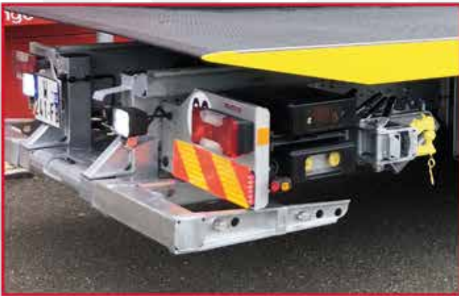
* Prises de démarrage 12V, chape d'attelage amovible et caméra de recul.
