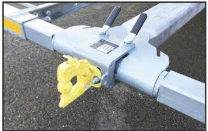
* Chape + boule adaptable sur panier de remorquage.
