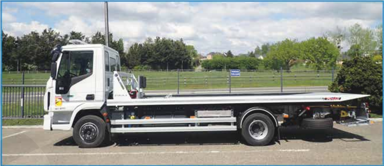
Capacité technique du plateau: 6500 Kg : Longueur : 5000 à 9000 mm.
