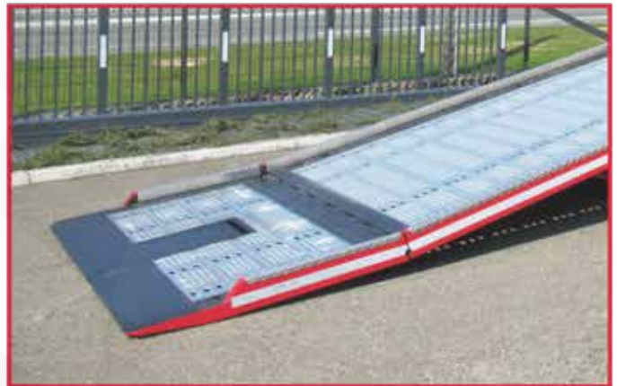
* Articulation arrière du plancher pour amélioration de l'angle de chargement.
