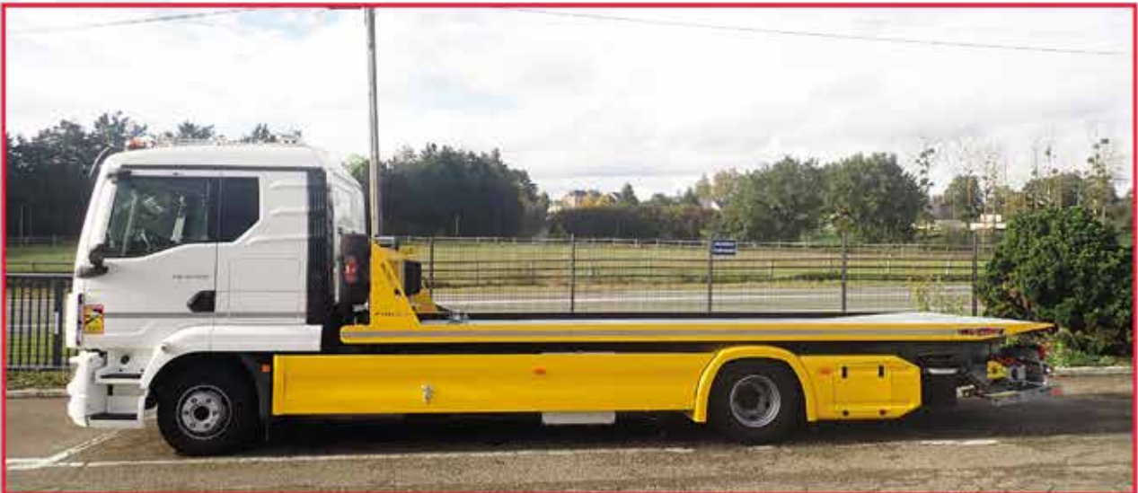
Plateau basculant-coulissant en acier anti-dérapant épaisseur 4/6 mm. Commande radio intégrale plateau-treuil.
