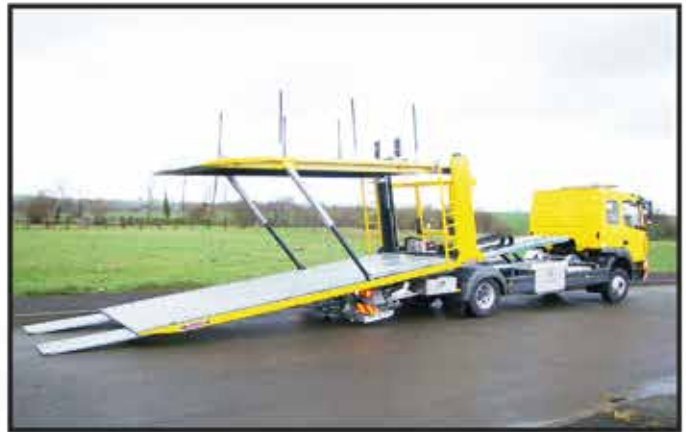
* Demi étage type 3 : élévation de l'AV par vérins + chaînes et élévation de l'AR par vérins.
