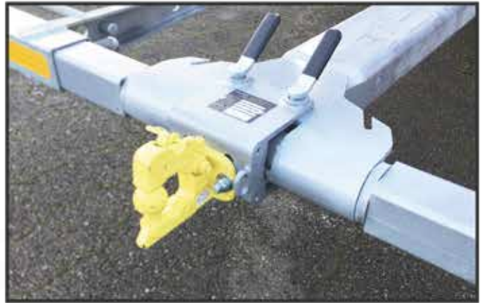
* Chape + boule adaptable sur panier de remorquage.
