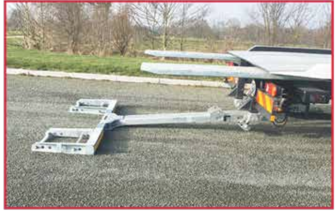
* Panier de remorquage avec double extension hydraulique à 1800mm et rampes hydrauliques.
