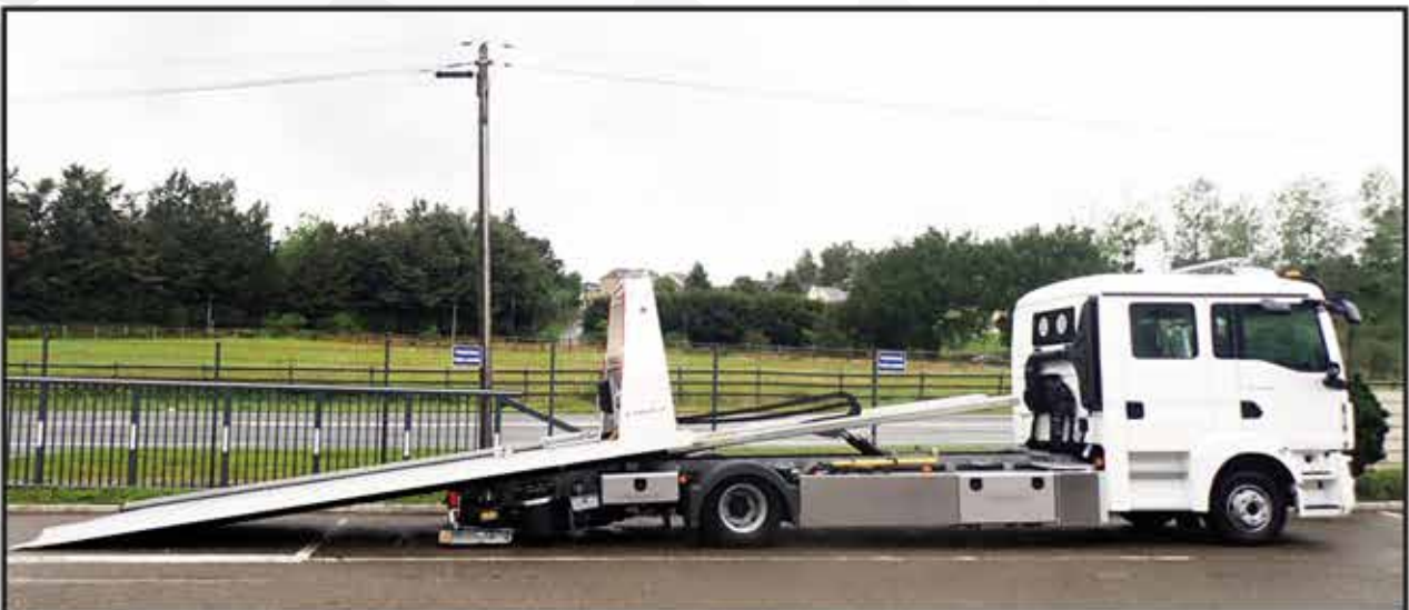
Coulissement du plateau sur patins de friction en nylon.
