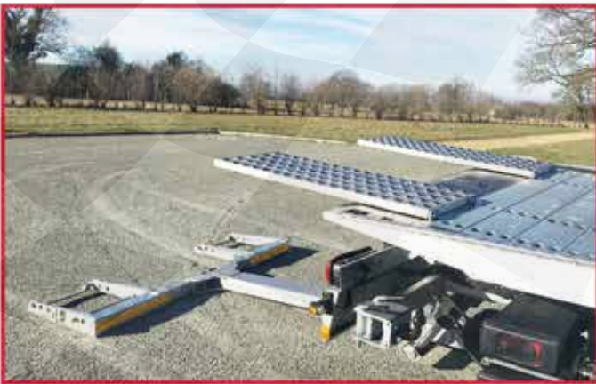
* Deux rampes aluminium 1250x500 mm adaptables en bout de plateau pour rallongement de celui-ci.
