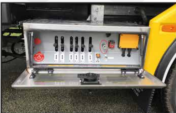
* Coffre de commandes hydrauliques avec prise d'air et débrayage pneumatique du treuil.
