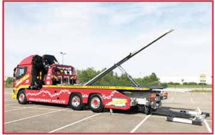
* Flèche hydraulique CRANELIFT, capacité 2T.
