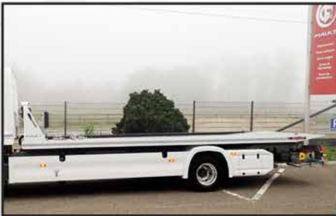
* Carénage stylisé en profilés d'aluminium avec ailes et coffres arrière en polyester.
