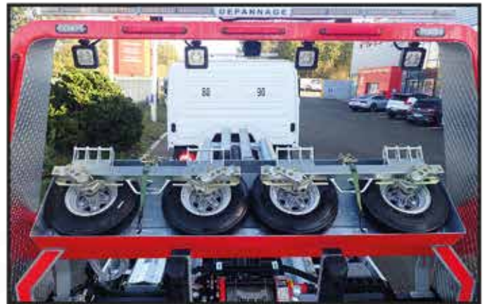
* Un support ouvert sur roll-bar pour chariot type SPEED DOLLY 1800 Kg zingué.
