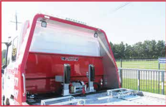
* Habillage du FLY type 3 avec doublage intérieur en aluminium et fermeture à mi-hauteur.
