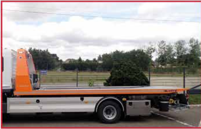
* Carénage stylisé de l'empattement en profilés d'aluminium anodisés avec ailes arrière en polyuréthane.
