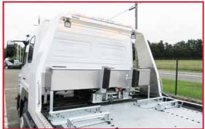
* Coffre à outils en inox avec ouverture par le dessus positionné sur la traverse du roll-bar.
