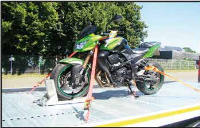
* Kit spécial cale moto avec sabot articulé, sangles et support sur l'équipement.
