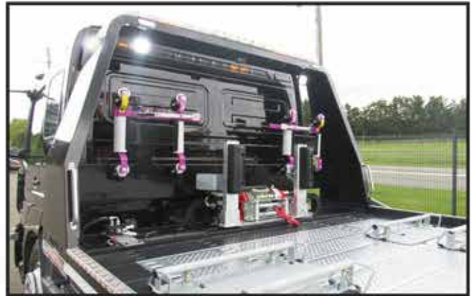
* Chariots à roues pivotantes, phares chromés en côté du FLY, poignées en inox et caméra de recul.
