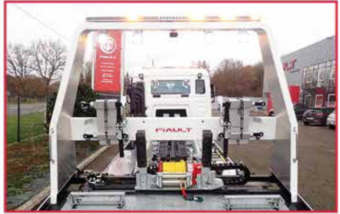
* Treuil hydraulique 7T1 en remplacement du treuil de 4T5 et crochet tournant.
