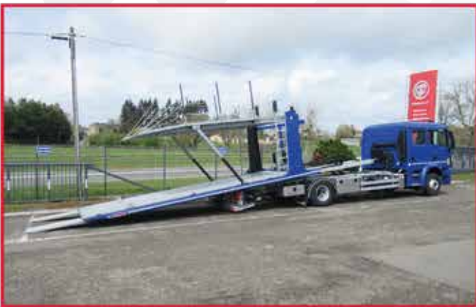
* Demi étage type 4 : élévation de l'AV par vis sans fin avec moteur hydraulique et élévation de l'AR par vérins.
