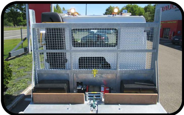
**\* Roll-bar spécial TP avec grillage de protection de cabine, 2 coffres de rangement et 2 bastings**
