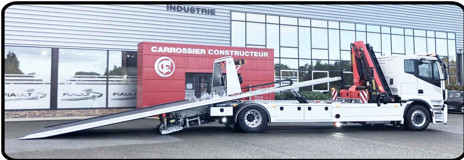
Capacité technique du plateau : 8000 Kg sur TP80 - 12000 Kg sur TP120 - 15000 Kg sur TP150.
