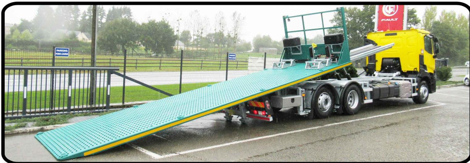
Longueur carrossable de 6500 à 10000 mm - largeur extérieure = 2550 mm. Fabrication intégralement sur mesure.
