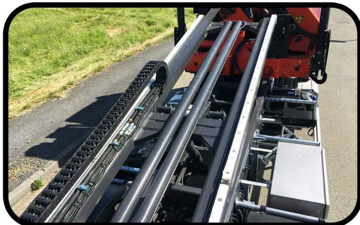
**\* Deux vérins de coulissement à double effet avec clapets de sécurité sur TP 120 et TP 150**
