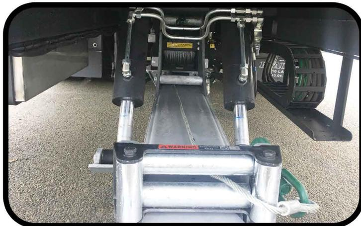
**\* Un treuil hydraulique 3T6 ou 4T5 installé sur le panier de remorquage avec une commande radio**
