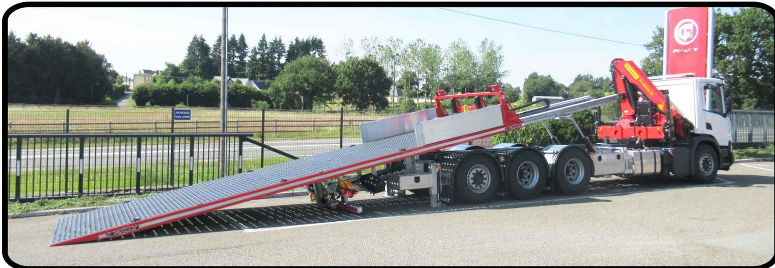
Plateau basculant-coulissant en acier anti-dérapant renforcé. Commande radio intégrale plateau - treuil.
