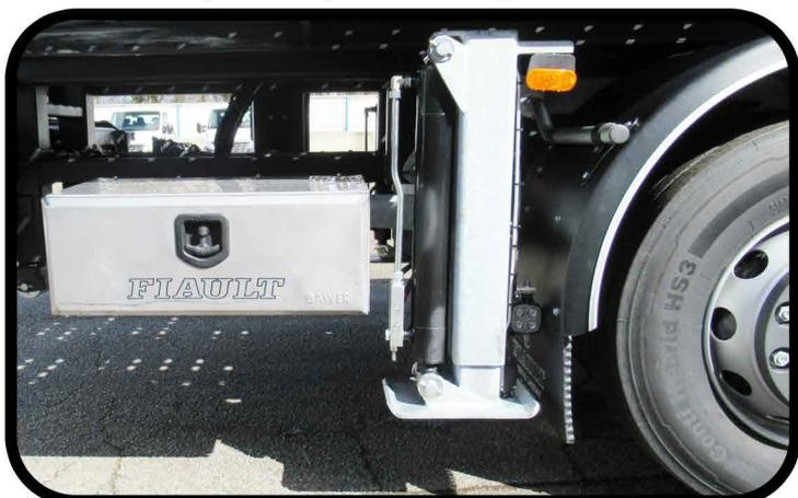
**- Deux béquilles arrière hydrauliques fixées sous le châssis sur une traverse derrière le dernier essieu**
