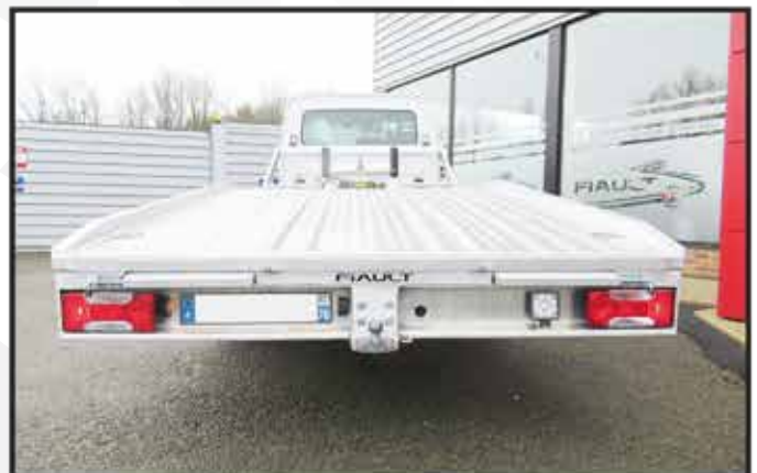
- Un crochet d'attelage à boule fixe diamètre 50mm à l'arrière.
