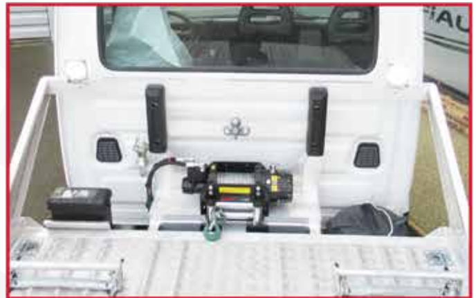
* Treuil hydraulique 3T6 avec circuit, pompe et réservoir en remplacement du treuil électrique.
