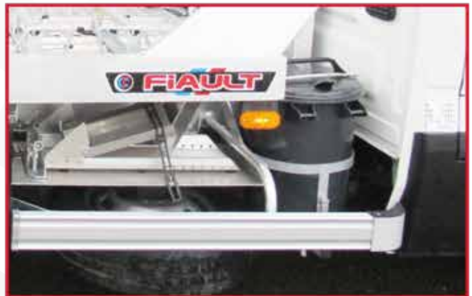
* Un bac à sable pour produit absorbant avec support.
