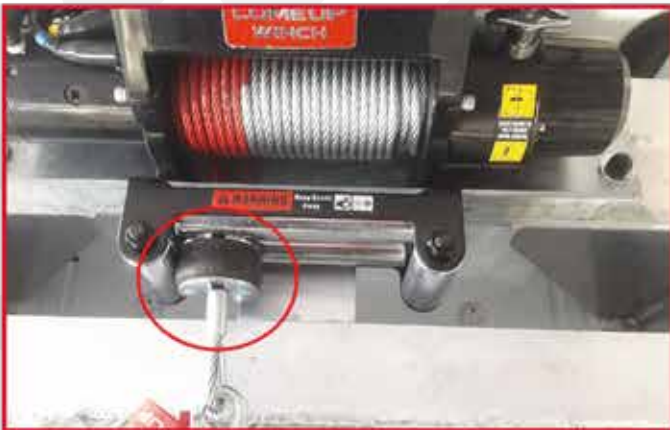
* Une butée de guide câble en caoutchouc pour câble de treuil.
