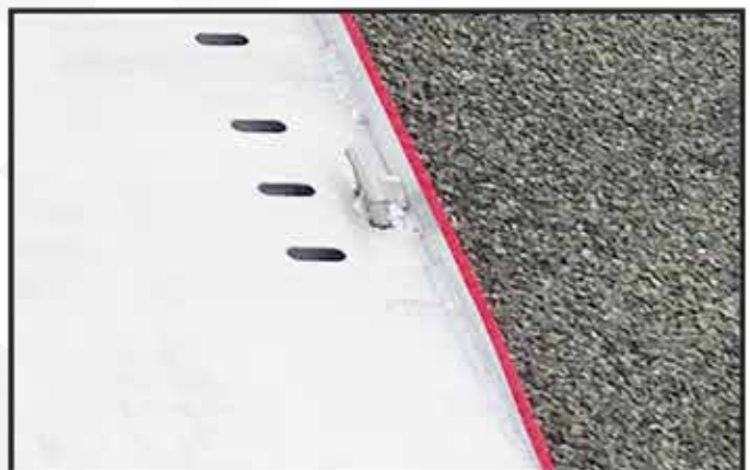
* Deux ou quatre ancrages emboîtables dans le plancher en aluminium pour arrimage.
