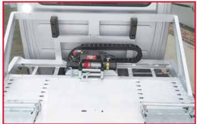
* Déplacement transversal du treuil avec commande manuelle.
