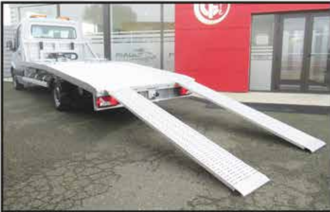
- Structure du plateau optimisée pour obtenir un faible angle de chargement et rampes de 2500mm.
