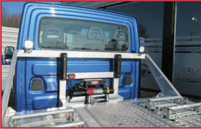
- Roll bar de protection de cabine avec butoirs caoutchouc.
