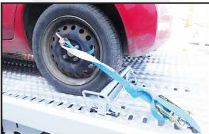
* Une sangle d'arrimage VL spéciale jante alu ou acier avec 1 boucle, 1 crochet et 1 cliquet.
