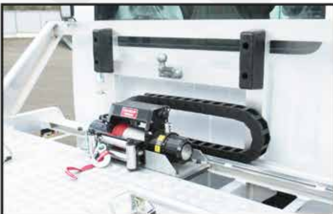
* Un crochet à boule fixe diamètre 50mm sur la face avant du plateau.
