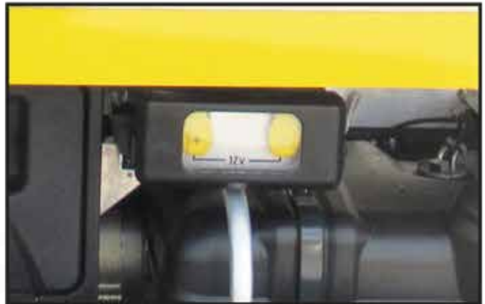
* Deux câbles de démarrage avec une prise 12V à l'avant droit de l'équipement.
