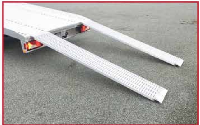
* Remplacement des rampes de chargement standards par des rampes en aluminium renforcées.
