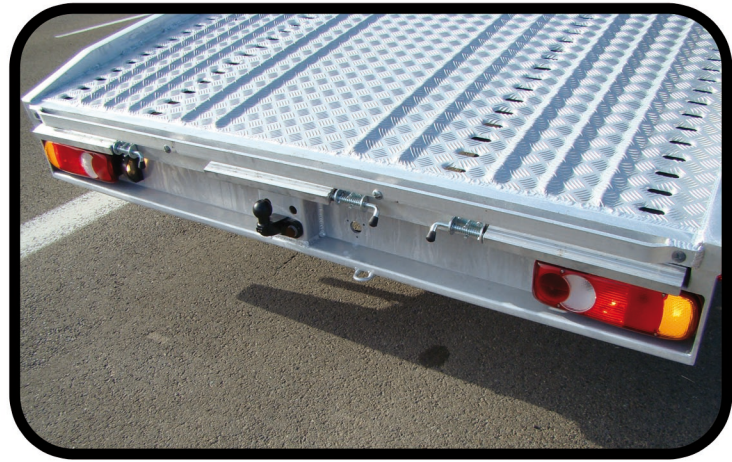
- Rampes de chargement encastées dans le plancher et réglables sur toute la largeur
