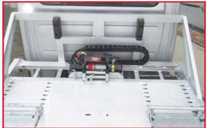
\* Déplacement transversal du treuil avec commande manuelle.
