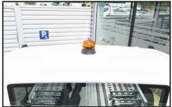
\* Un gyrophare à leds central installé à plat sur la cabine.
