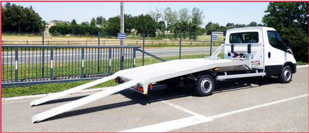
Equipement fabriqué sur mesure suivant la configuration du châssis cabine afin d'obtenir le meilleur angle de chargement.
