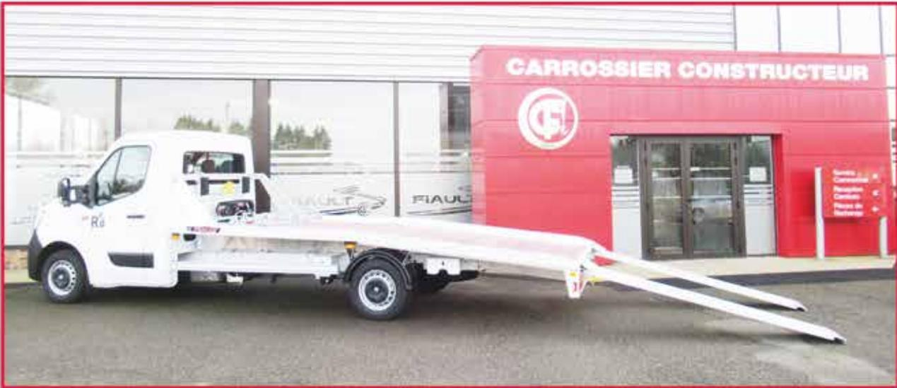
Plateau porte voiture FIXE réalisé entièrement en ALUMINIUM avec une structure soudée monobloc sans boulonnage.
