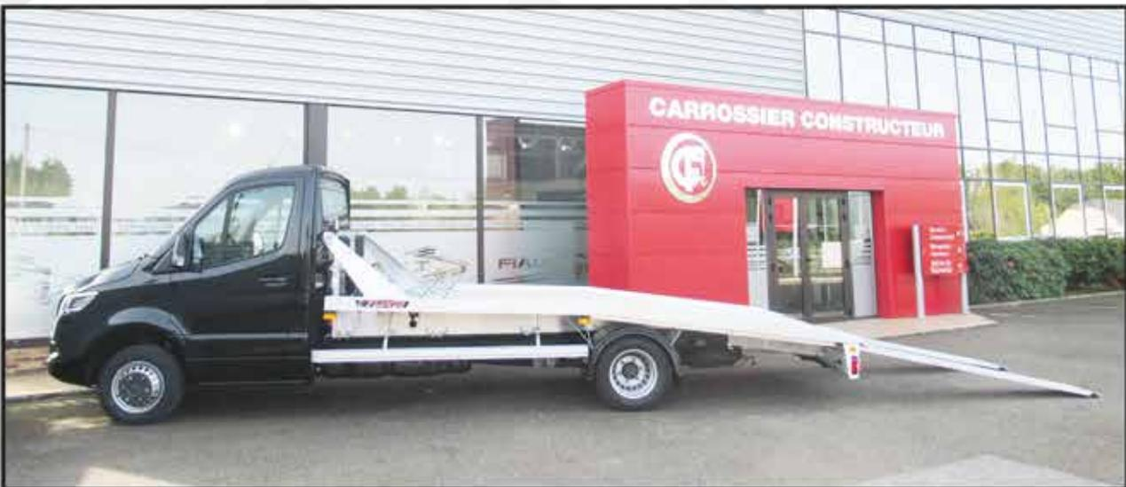
Plancher et rampes en tôles d'aluminium de 3mm anti-dérapantes et entièrement soudées.
