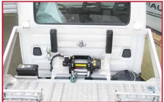
\* Treuil hydraulique 3T6 avec circuit, pompe et réservoir en remplacement du treuil électrique.
