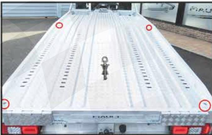
\* Un diabolo de renvoi de câble avec 4 emboîtements dans le plancher (2 par côté) et support.
