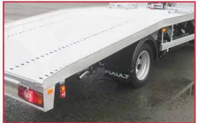
* Protections inox sur le dessus des rives du plateau avec plats 10mm (plancher autoportant).
