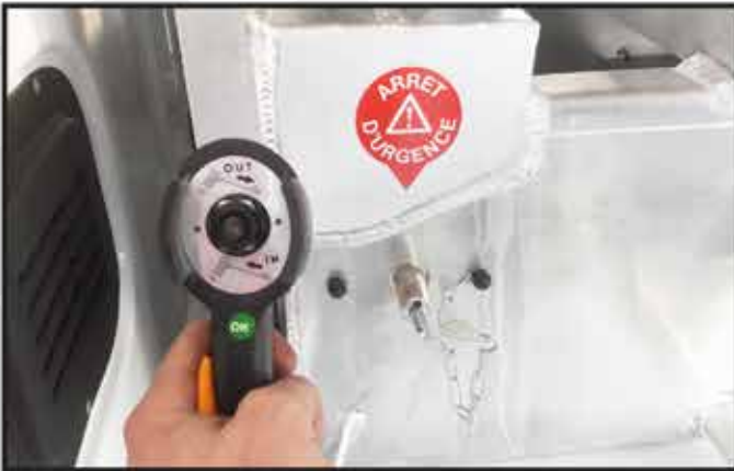
- Commande par fil d'origine pour enroulement et déroulement du treuil électrique et coupe circuit.
