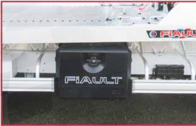
* Un coffre à outils en polyuréthane anti-choc longueur 600mm.
