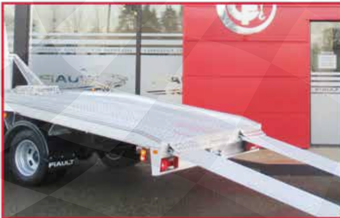
* Protections alu anti-dérapantes sur le dessus des rives tubulaires 50mm du plateau (plancher nervuré).
