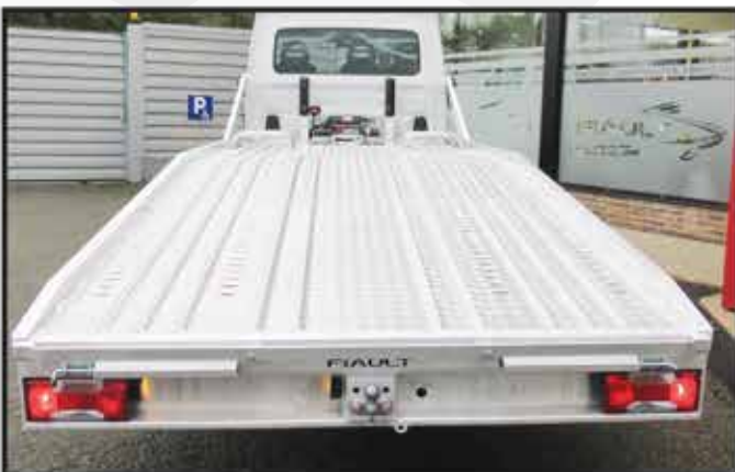
- Plancher aluminium en tôles à larmes anti-dérapantes avec NERVURES de renfort (largeur utile 2000mm).
