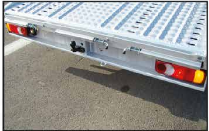
- Rampes de chargement encastrées dans le plancher et réglables sur toute la largeur.
