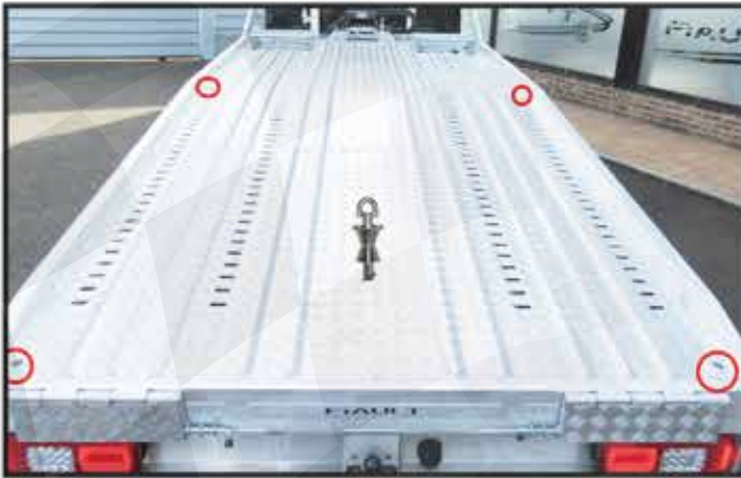
* Un diablo de renvoi de câble avec 4 emboîtements dans le plancher (2 par côté) et support.
