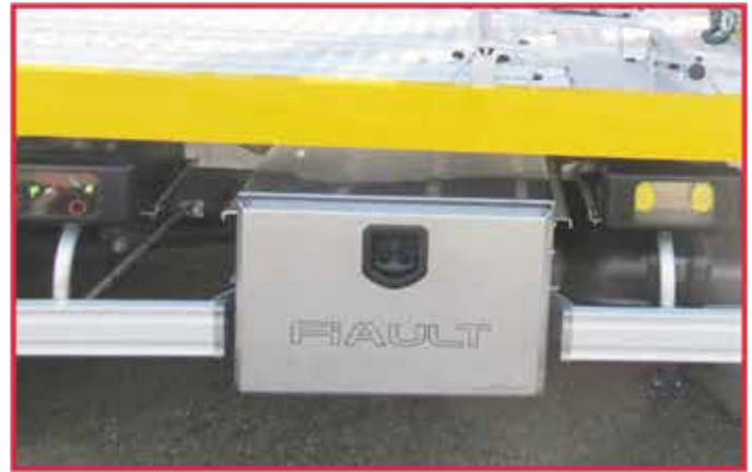
* Un coffre à outils en inox avec porte articulée longueur 600 mm.
