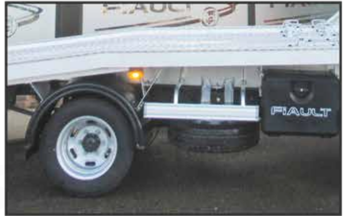
* Un porte-roue de secours fixé en côté du châssis dans l'empattement.
