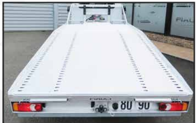
* Plancher aluminium AUTOPORTANT anti-dérapant sans nervures de renfort (largeur utile 2080mm).
