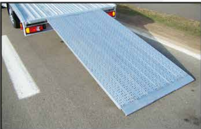
* Une troisième rampe de chargement centrale en aluminium pour chargements spéciaux.
