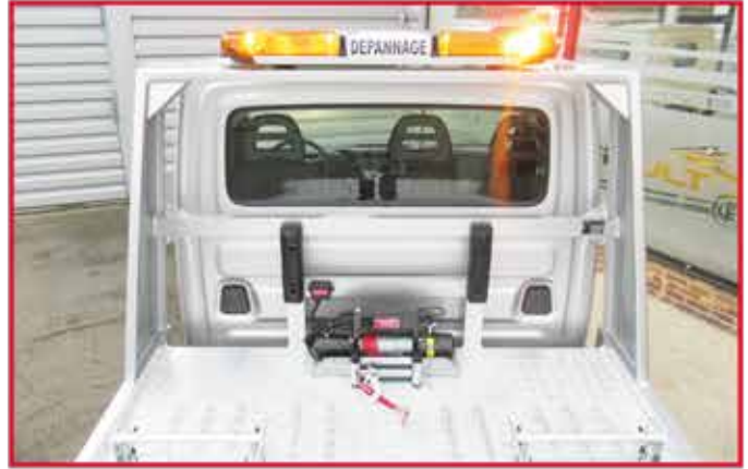
* Roll-bar avant surélevé type FLY standard avec rampe lumineuse à gyrophares ou à leds.
