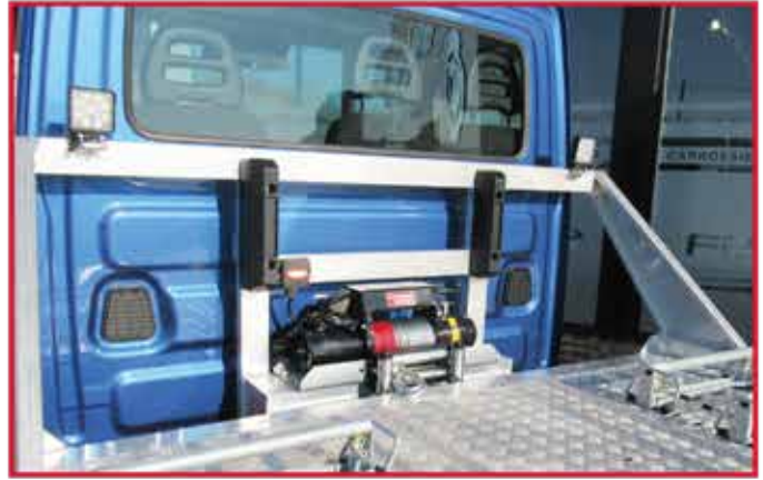
* Deux phares de travail à leds orientables fixés à l'avant de l'équipement.
