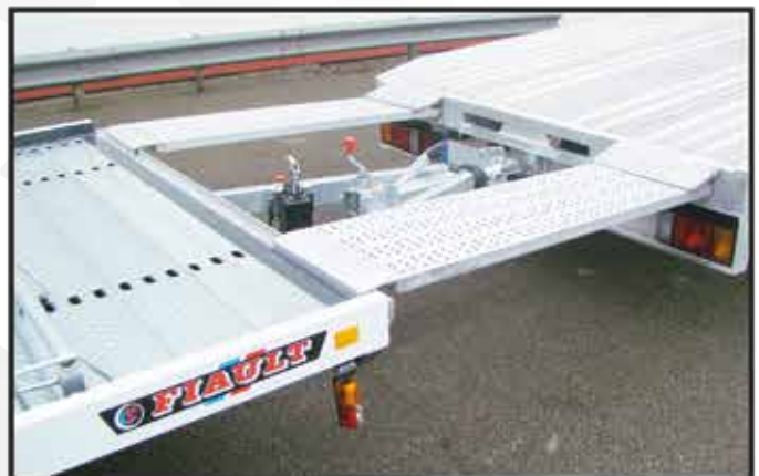
* Rampes de chargement non réglables avec bas volets pour passage sur remorque sans décrocher.
