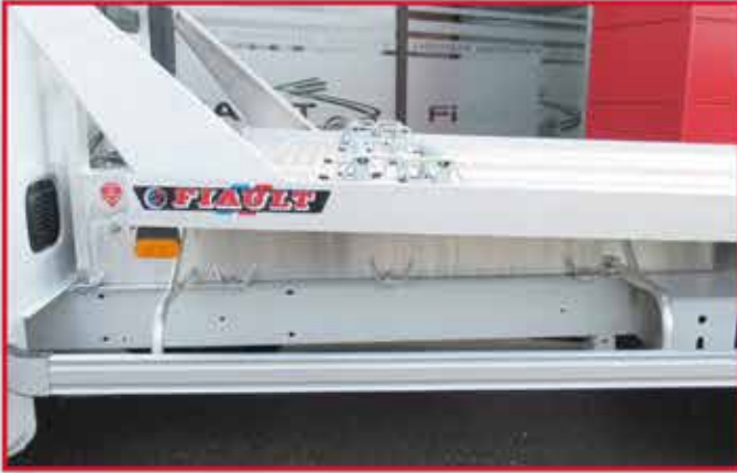
- Faux châssis et plateau les plus légers du marché avec structure 100% aluminium.
