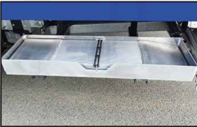
* Deux rampes aluminium 1000mm pour amélioration de l'angle de chargement avec un support.
