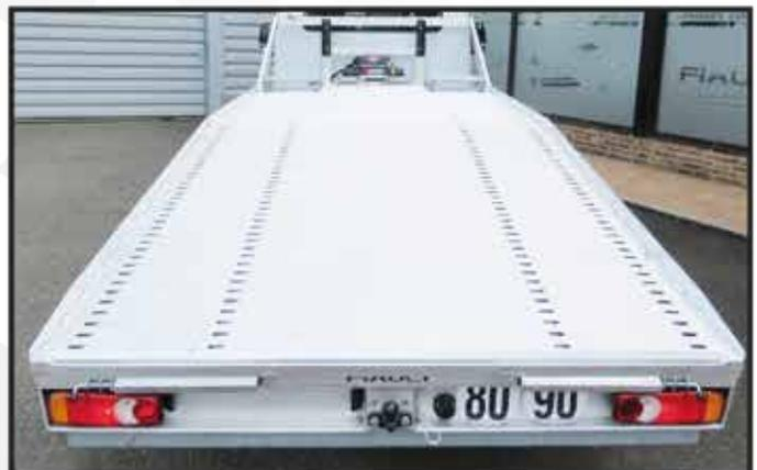
\* Plancher aluminium AUTOPORTANT anti-dérapant sans nervures de renfort (largeur utile 2080mm).
