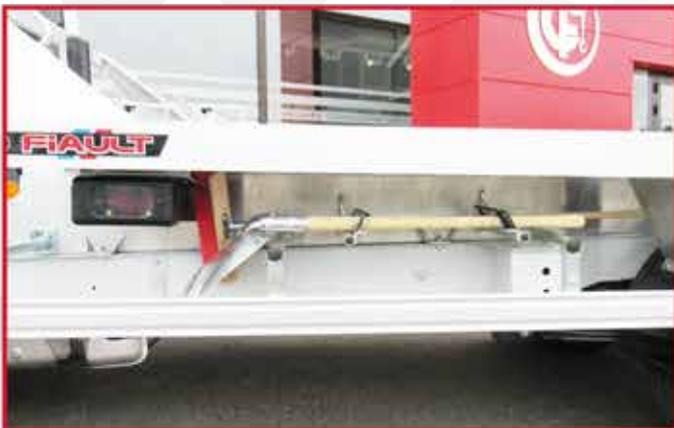
\* Trois gilets, trois cônes pliants, une pelle et un balai avec supports et deux extincteurs dans un coffre.
