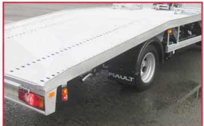
\* Protections inox sur le dessus des rives du plateau avec plats 10mm (plancher autoportant).
