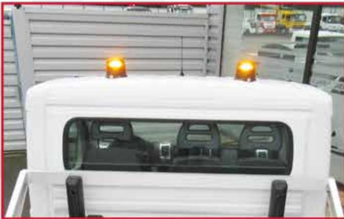
\* Deux gyrophares à leds installés à plat sur la cabine.
