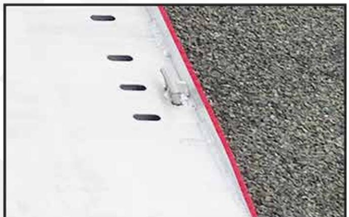
\* Deux ou quatre ancrages emboîtables dans le plancher en aluminium pour arrimage.
