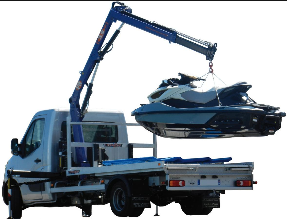
Faux-châssis acier - Plateau 100% Aluminium soudé - Longueur 3500 mm x Largeur : 2100 mm.
